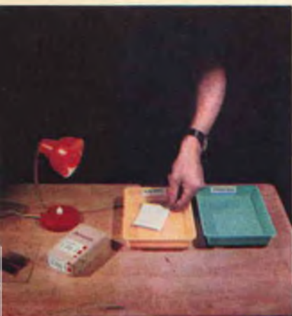
Fig. 10 - Controlleremo sempre la carta nel bagno di sviluppo per evitare che rimanendo un tempo superiore al necessario, si presenti al termine dell'operazione troppo scura. Non dimenticheremo che occorre sempre utilizzare la sola luce rossa.
