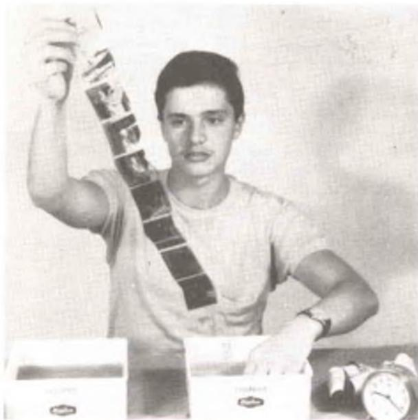
**Fig. 12 -** Trascorsi circa 10 minuti di permanenza nel bagno di fissaggio, potremo accendere la luce e quindi vedere i nostri negativi già sviluppati. Avrete così constatato che sviluppare i negativi è cosa facilissima.
