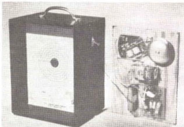
**Fig. 2 - La foto ci fa vedere su una basetta di legno tutto l'impianto elettronico, mentre nella casetta è visibile il bersaglio con i suoi vari cerchi e con al centro, chiaramente visibile, la fotoresistenza.**
