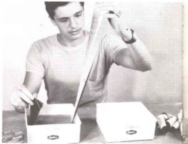
**Fig. 9** - E' molto utile muovere la pellicola mentre si trova nel bagno di sviluppo. Si può sfilarla, rimetterla continuamente nel bagno con movimenti alterni, affinché non accada che qualche bolla d'aria, rimanendo in mezzo alla pellicola arrotolata, impedisca il contatto con lo sviluppo e possa causare che delle parti non vengano completamente sviluppate.
