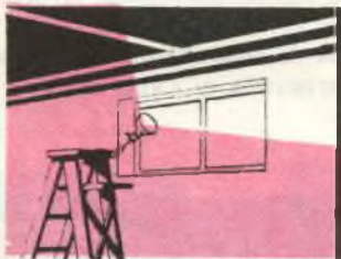
Fig. 7 - Queste lampade sono utili per sgelare le tubazioni dell'acqua, e questo senza arrecare danni o sporcare le pareti
