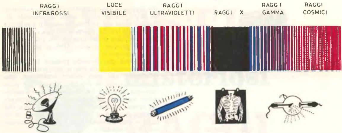
Fig. 1 - I raggi infrarossi sono della stessa natura delle onde radio. Infatti al limite di queste si passa ai RAGGI INFRAROSSI, la cui lunghezza d'onda è di poco inferiore al millimetro per arrivare al millesimo di millimetro, se si riduce ancora questa lunghezza d'onda si arriva a quella della LUCE VISIBILE poi a quella dei RAGGI ULTRAVIOLETTI per passare in seguito ai raggi X e a quelli GAMMA come vedesi nel disegno riportato.
