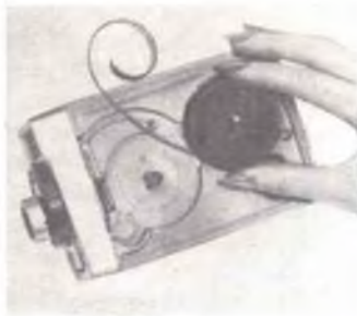
Fig. 2 - Per caricare la macchina, svolgete circa 30 centimetri di pellicola, la bobina con la pellicola andrà posta sul perno di destra, come si vede nella foto.
