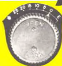
Fig. 10 - Quando l'indice indicherà 0 (vedi foto sopra) dovremo prima di aprire il coperchio far funzionare la cinepresa fintanto che l'indice non arriva sulla lettera E.
