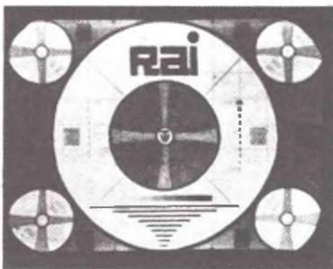
Fig. 5 - Adoperando uno degli amplificatori di antenna che proponiamo in questo articolo, il monoscopio ha assunto il necessario contrasto. L'immagine si presenta regolare, come testimonia la fotografia visibile in figura.
