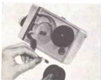
Fig. 6 - L'estremità dello spessore di pellicola verrà ora agganziata alla fessura di cui è provvisto il perno della bobina vuota.
