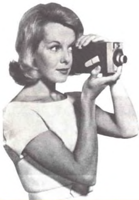
Fig. 11 - La cinepresa s'impugna come visibile nella foto. L'indice della mano destra servirà a spingere il pulsante di avvio presente sul davanti.
