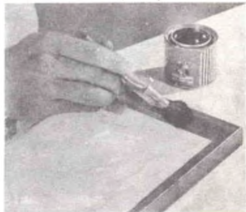
Fig. 6 - Questo sistema può servire non solo per la statua, ma anche per cornici, lampadari o altro. Prima operazione sarà sempre quella di spalmare un collante sulle superfici da dorare.
