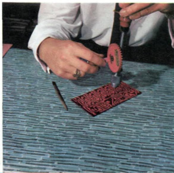
Fig. 11 - Con un trapanino ed una punta da 1,5 mm. effettueremo i fori sul circuito stampato necessari al fissaggio dei vari componenti. Punte di diametro maggiore saranno impiegate per la foratura delle sedi dei componenti più ingombranti.
