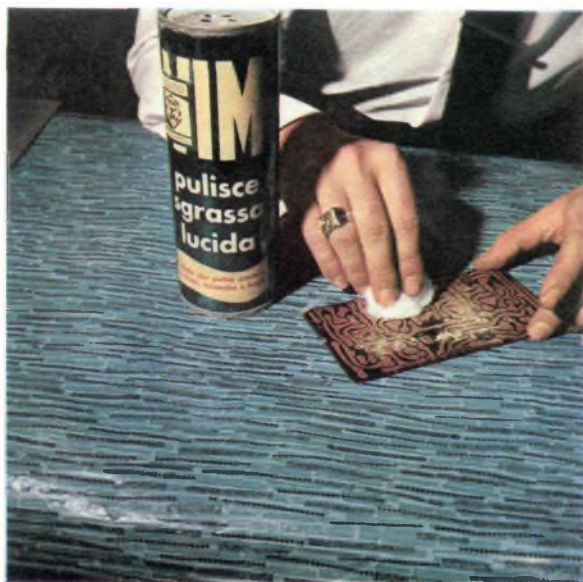
Fig. 10 - Con comune soda o altro detergente che sia pure moderatamente abrasivo (quale il VIM, AIA, ecc.) lucideremo il rame in modo che la saldatura sia agevole. In questo modo pure eventuali tracce di grasso potranno facilmente essere eliminate.
