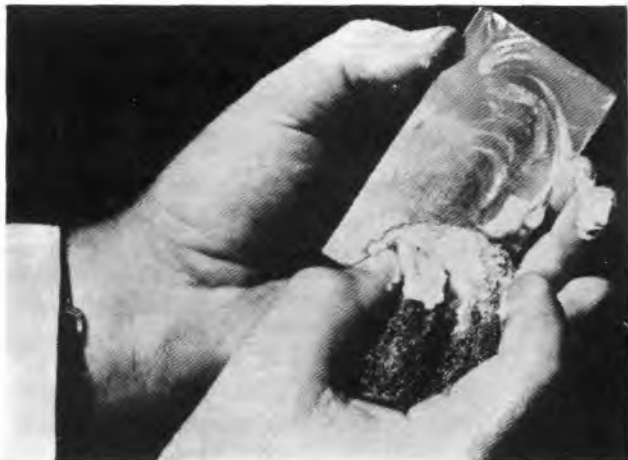
Fig. 1 - Sarà sempre buona norma (per quanto non strettamente indispensabile, data l'efficienza della nostra soluzione corrosiva), pulire la lastrina di rame con sapone e soda comune per togliere ogni traccia di sporco.
