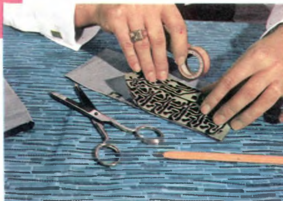
Fig. 4 - Una volta ricopiato su carta lucida il disegno da riprodurre, esso verrà fissato sulla piastrina di rame con nastro adesivo, non dimenticando, ovviamente, di inserire, fra disegno e piastrina, la carta carbone.
