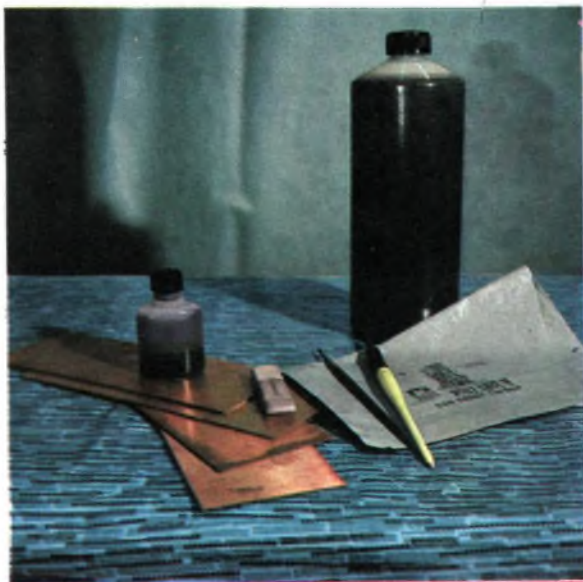
Fig. 3 - Il materiale necessario alla realizzazione del circuito stampato non costituisce certamente un problema né di costo né di reperibilità: nella foto potete vedere il bottiglione contenente la soluzione corrosiva, la bottiglia dell'inchiostro protettivo, la carta carbone ed il pennellino necessario per coprire le zone di maggior estensione.
