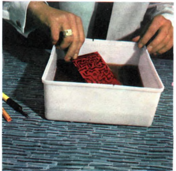
Fig. 7 - Quando l'inchiostro si sarà completamente asciugato potrete immergere la lastrina in una bacinella di plastica contenente la soluzione corrosiva. Agitando la soluzione o riscaldandola, si riduce il tempo necessario alla corrosione.
