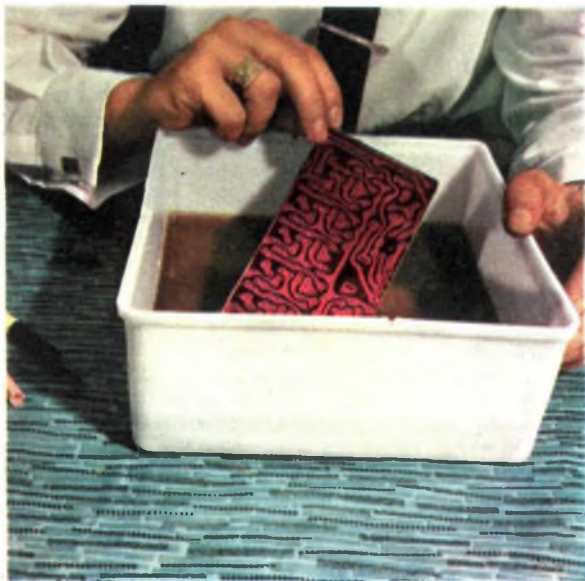
Fig. 8 - Dopo circa 20 minuti potremo controllare la nostra lastrina; se vediamo che tutto il rame non coperto dall'inchiostro è asportato potremo toglierla dal bagno, diversamente faremo continuare il procedimento di sviluppo per ancora qualche minuto.
