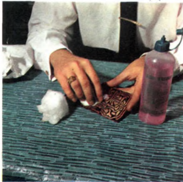
Fig. 9 - Tolta la piastrina dal bagno, è necessario ora asportare dal circuito stampato l'inchiostro protettivo. Per questa operazione è sufficiente l'impiego di un batuffolo di cotone imbevuto di comune alcool denaturato.
