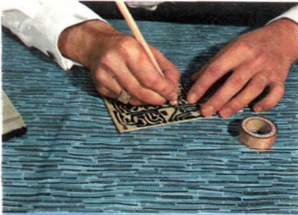
Fig. 5 - Con una biro ricalcate tutti i contorni del disegno in modo che la carta carbone lo riproduca sulla lastrina di rame. Prima di togliere la carta lucida assicuratevi di aver passato il disegno al completo.
