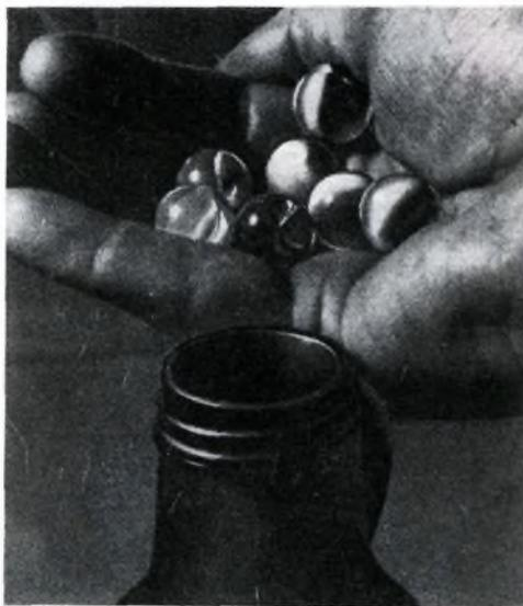
La soluzione di sviluppo impiegata in fotografia, si mantiene inalterata più a lungo se nella bottiglia che la contiene non rimane aria. Sarà, quindi, opportuno — ogni qualvolta il livello del liquido si abbassa a causa dell'uso — versare nell'interno della bottiglia tante palline di vetro quante ne bastano per far risalire fino all'orlo il livello stesso.
