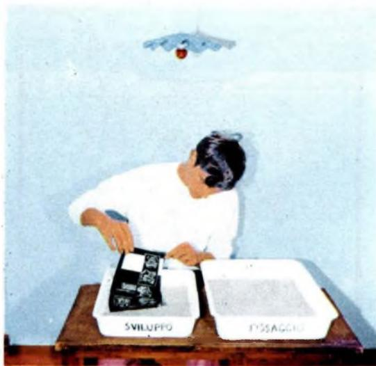
Fig. 6 - Quando noterete, sempre alla sola luce, che il foglio di carta graforeflex è diventato nero mentre le scritte o i disegni appaiono bianchi, come potrete constatare nella figura 12, dovrete togliere dal bagno di Sviluppo per immergerlo in quello di Fissaggio. Se, inavvertitamente, lascerete ancora il negativo nel bagno di sviluppo, a poco a poco anche la scritta diventerà nera; in questo caso occorrerà ripetere l'operazione.
