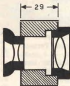
Fig. 3 - La distanza fra oculare e obiettivo, con le lenti da noi fornite, deve essere esattamente di 29 mm. Distanze diverse non permetterebbero di mettere a fuoco l'immagine. Usando lenti diverse dovrete cercare, sperimentalmente, la distanza di messa a fuoco che potrà anche notevolmente variare da quella da noi indicata.
