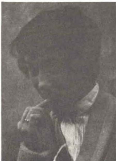
Fig. 1 - Un negativo normale, stampato su carta MORBIDA ha una prevalenza di toni grigi e neri (mancano i bianchi, vedi viso e camicia). Tale inconveniente si manifesta anche se il tempo di esposizione o la permanenza nel bagno di sviluppo risulta superiore al necessario.
