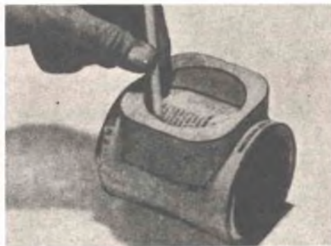
Fig. 2 - Il tubo orizzontale dovrà essere provvisto di due fori, uno per lasciare passare la luce che dovrà raggiungere la negativa e l'altro, più piccolo, dalla parte opposta, per raffreddare il corpo dell'ingranditore.
