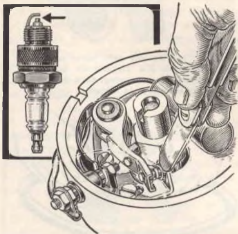
Fig. 4 - Sarebbe indispensabile dotare la vettura anche di una serie di puntine platinatate per lo spinterogeno; se non lo avete, non dimenticate, però, di portare sempre con voi una limetta per le unghie: potrà esservi necessaria per pulire le puntine stesse o per togliere eventuali incrostazioni dalle candele.
