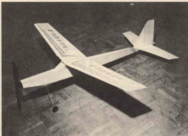
Fig. 9 - Terminata la messa a punto del velivolo e corretta ogni più piccola imperfezione di volo, potrete procedere alla verniciatura. La stessa ditta, potrà fornirvi, dietro richiesta, vasetti di vernici alla nitro nei colori preferiti: giallo, rosso, azzurro, verde. Il vostro modello così rifinito si presenterà perfetto anche esteticamente.
