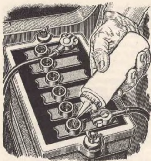
Fig. 7 - La batteria della vostra auto durerà molto più a lungo e sarà in grado di erogare maggior corrente se l'elettrolita ricoprirà le piastre di piombo per almeno un centimetro. Sappiate che per mantenere l'elettroliti a livello costante, basterà aggiungere dell'acqua distillata che è la sola ad evaporare.
