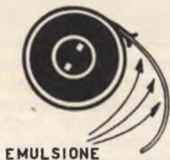
Fig. 7 - Terminato l'avvolgimento della pellicola sul rocchetto e chiuso completamente il caricatore, potrete controllare alla luce se il lembo della pellicola che fuoriesce dal caricatore, ha l'emulsione sensibile rivolta verso l'interno.
