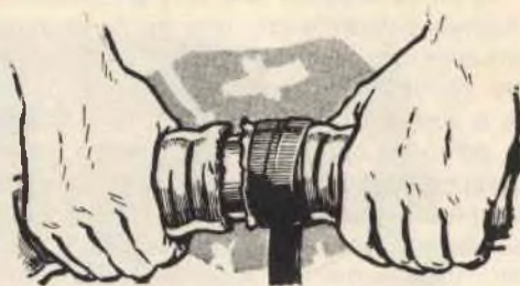
Fig. 1 - Per riparare provvisoriamente i tubi del radiatore che si fossero screpolati, potete servirvi di nastro adesivo, come mostra la figura.
