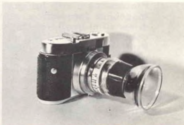
Fig. 4 - La lente LUPE-8X verrà fissata con nastro adesivo all'obiettivo della macchina fotografica. Dovremo cercare di porre la lente perfettamente parallela all'obiettivo della macchina stessa, onde ottenere una perfetta messa a fuoco del campo abbracciato.
