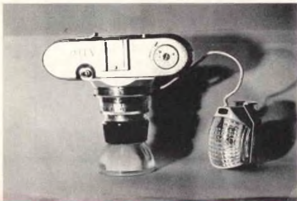
Fig. 5 - Poiché il fattore LUCE è di vitale importanza nella macrofotografia, sarà indispensabile, per ottenere risultati eccellenti, una fonte di illuminazione supplementare. Essa può essere costituita da un flash elettronico. A fig. 9 viene illustrato un altro semplice sistema d'illuminazione che ha il pregio di illuminare il soggetto da ogni lato.
