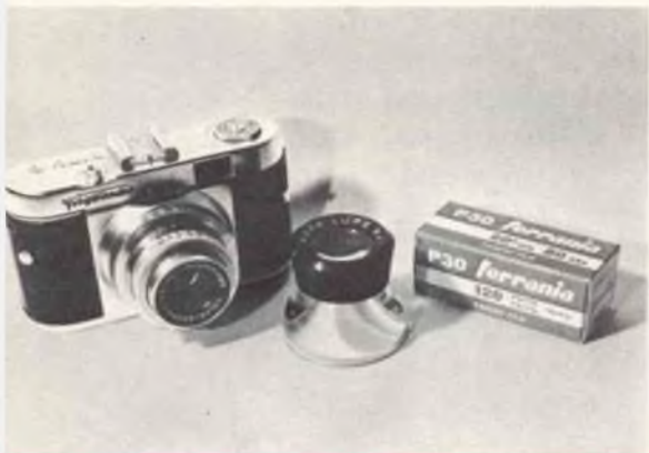
Fig. 3 - Il materiale da noi usato per la macrofotografia è decisamente modesto: una comune macchina fotografica Voiglander (serve allo scopo qualsiasi macchina fotografica), una pellicola P30 Ferrania ed una lente d'ingrandimento tipo LUPE-8X dell'AGFA reperibile in ogni negozio fotografico.
