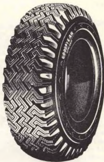
Fig. 13 - La Good Year costruisce per la neve l'Ultra-dip. Il profilo del battistrada è composto da elementi a L in gomma morbida che permette una marcia silenziosa anche su strade asciutte.
