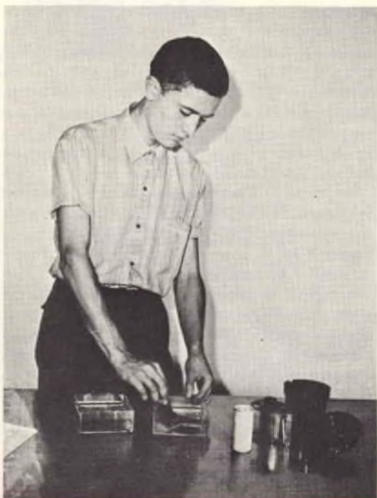
Fig. 13 - A negativa lavata, immergetela nel secondo bagno che avrete avuto l'avvertenza di preparare in precedenza in una bacinella a parte. Nel secondo bagno la negativa può rimanere immersa anche 10-20 minuti (tempo normale 8 minuti) dopo di che andrà tolta, lavata abbondantemente e messa ad asciugare.
