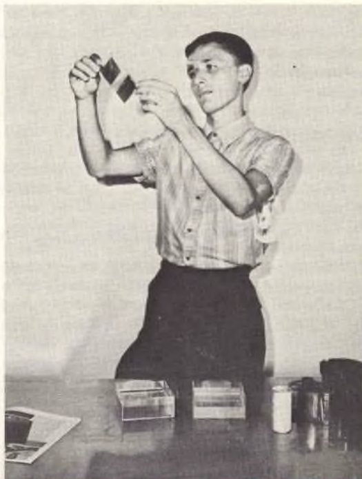
Fig. 12 - Togliete ora la negativa dal bagno di indebolimento e lavatela abbondantemente in acqua corrente per almeno cinque minuti, onde togliere dalla sua superficie qualsiasi residuo di acido. Tutte queste operazioni possono essere eseguite alla luce.
