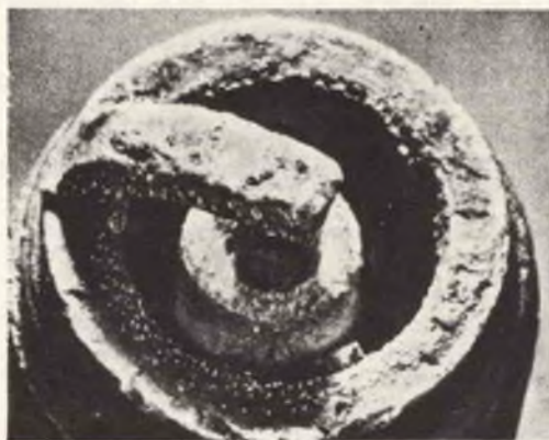
Fig. 10 - Nel caso si notino sulla superficie della candela delle perline metalliche, o della polvere biancastra, è perché la candela impiegata nel vostro motore è troppo calda. Si dovrà quindi sostituirla con una più fredda.
