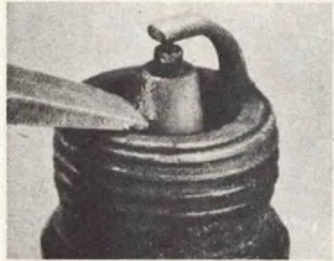
Fig. 8 - Possiamo stabilire se la candela impiegata nel nostro motore è della gradazione richiesta, controllando l'isolante di questa dopo un migliaio di Km. Una candela con gradazione giusta avrà la ceramica ricoperta da un leggero strato di deposito, che può andare dal grigio al rossastro.
