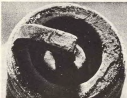
Fig. 9 - Se notate sulla candela dei depositi asciutti di color nero, ciò sta a significare che la candela impiegata nel vostro motore è troppo fredda. In questi casi dovrete scegliere una candela leggermente più calda.
