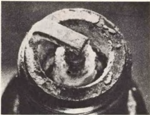
Fig. 11 - Se l'isolante della vostra candela si screpola con facilità, oppure gli elettrodi dopo un migliaio di chilometri risultano notevolmente consumati, dovrete dedurre che al vostro motore è stata applicata una candela troppo calda, quindi inadatta.
