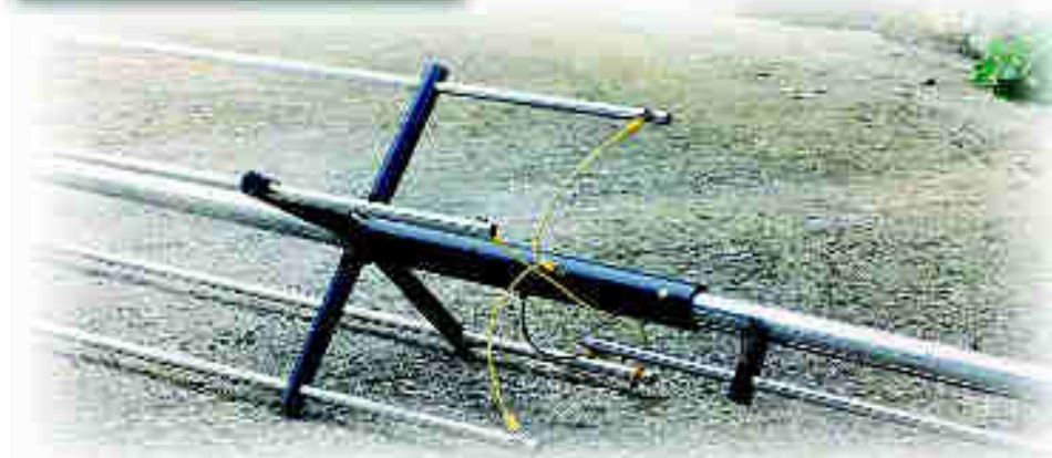
La GAP TITAN DX en cours de montage. Notez le câble coaxial jaune qui traverse le boom principal. Il est raccordé à une grosse capacité.
