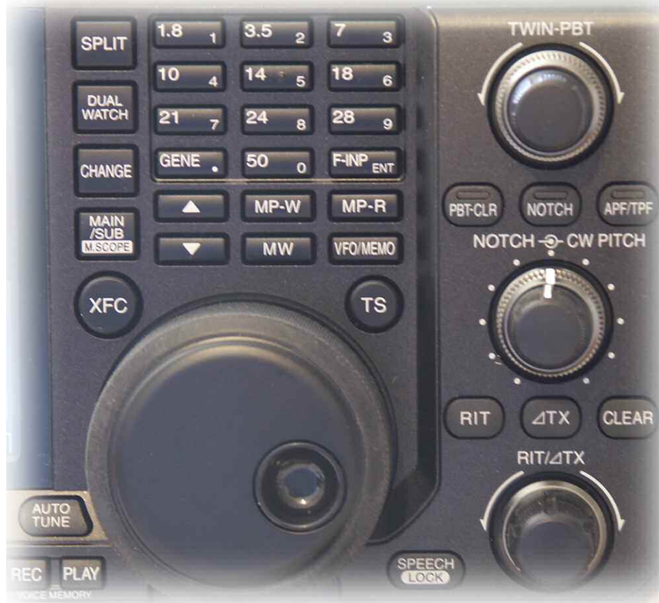
La partie gauche du poste regroupe des fonctions devenues essentielles en ondes courtes, le PBT et le NOTCH. Très efficaces ici.
