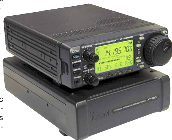
Ci-dessus, les fusibles sont des modèles en verre. Ci-dessous, la boîte d'accord externe AT-180 avec un IC-706. Cette boîte s'accorde parfaitement de nombreux transceivers de la marque, dont le IC-7200.
