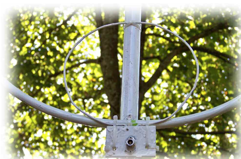
Ci-contre un gros plan de l'antenne cadre magnétique au niveau du connecteur. Ci-dessus le schéma équivalent et simplifié de ce genre d'antenne.
