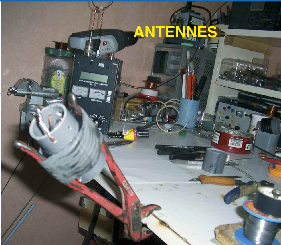
Une bonne astuce pour passer la chambre à air protectrice autour des spires.
