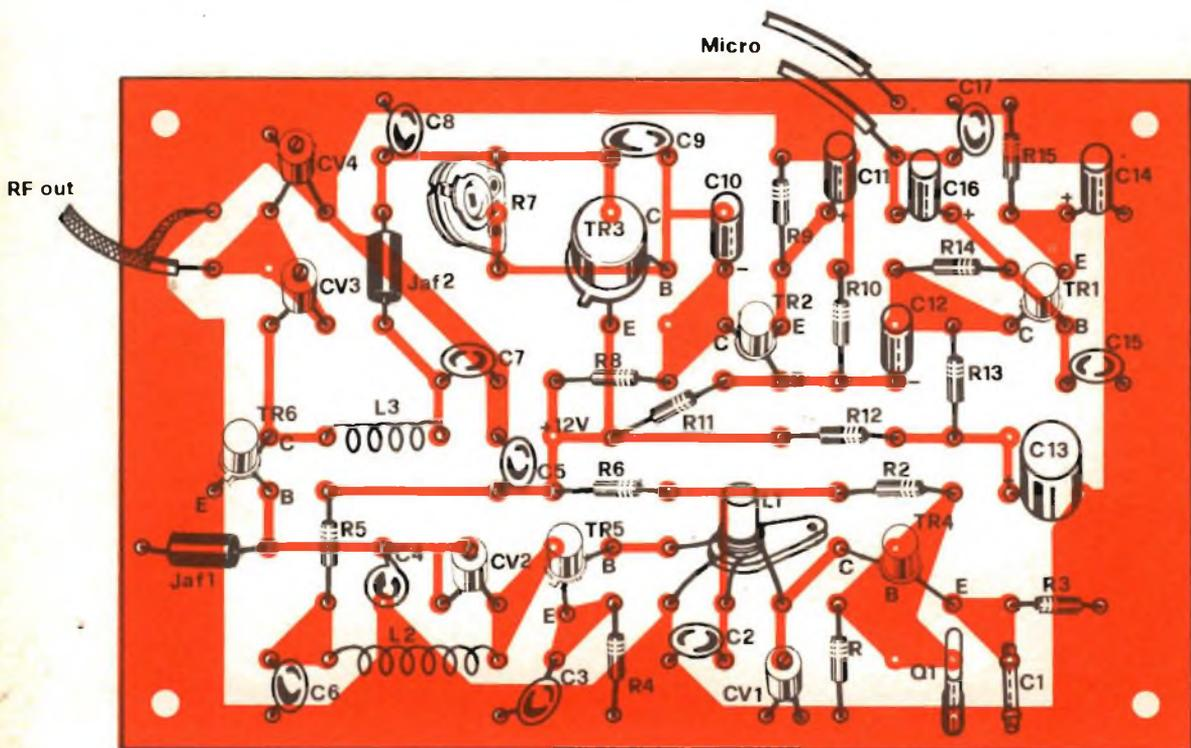
Essendo il trasmettitore un dispositivo operante ad alta frequenza la basetta stampata su cui fisseremo i componenti dovrà preferibilmente essere del tipo in vetronite; in quanto, tale materiale, è più compatibile con le reazioni che si manifestano nei circuiti oscillanti ad alta frequenza. Considerata questa premessa supponiamo di aver estratto dall'apposita bacinel-
