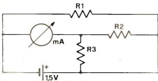
Nel circuitino qui riportato una pila da 1,5 V alimenta tre resistenze. Il mA sarà certamente percorso da una corrente; provate a calcolarla tenendo conto che R1, R2, R3, sono tutti resistori da 3,3 Kohm e che quindi, se avete dei dubbi possono essere facilmente acquistati per trovare sperimentalmente il risultato. La soluzione che riterremo più completa (illustrare chiaramente il procedimento di calcolo) sarà premiata con un abbonamento senza libro dono a Radio Elettronica.
