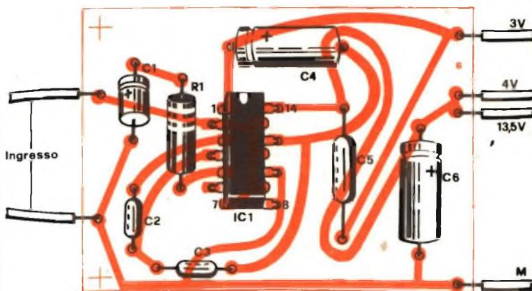
Disposizione dei componenti circuitali sulla basetta stampata. E' importante rispettare l'inserzione dell'integrato.
