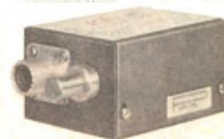
Preamplificatore d'antenna per migliorare il rendimento del ricevitore.
