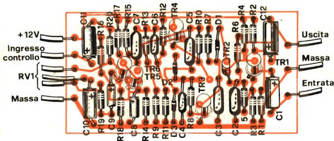
Tutti i componenti all'infuori del potenziometro di regolazione sono cablati sul supporto stampato di ridotte dimensioni.
