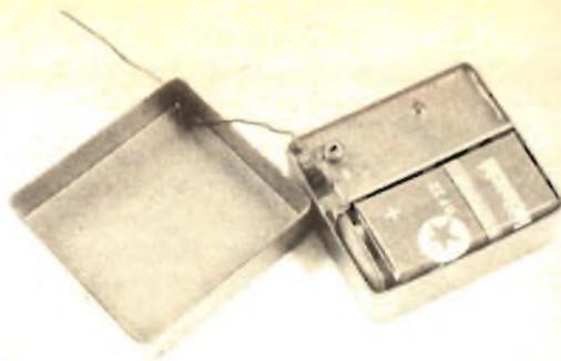
Accanto all'interruttore un punto di regolazione per variare la frequenza d'emissione. La taratura permette di variare la frequenza nella banda FM compresa fra 88 e 108 MHz.
