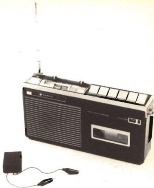
Il radio-registratore venduto già modificato per il funzionamento automatizzato. Il nastro inizia a scorrere quando un segnale giunge al ricevitore sintonizzato.
