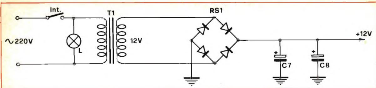
Per alimentare il complesso elettronico per comunicazioni a doppia via lo schema che vi proponiamo è una valida soluzione per eliminare le batterie (elementi sconvenienti causa la periodica sostituzione).
