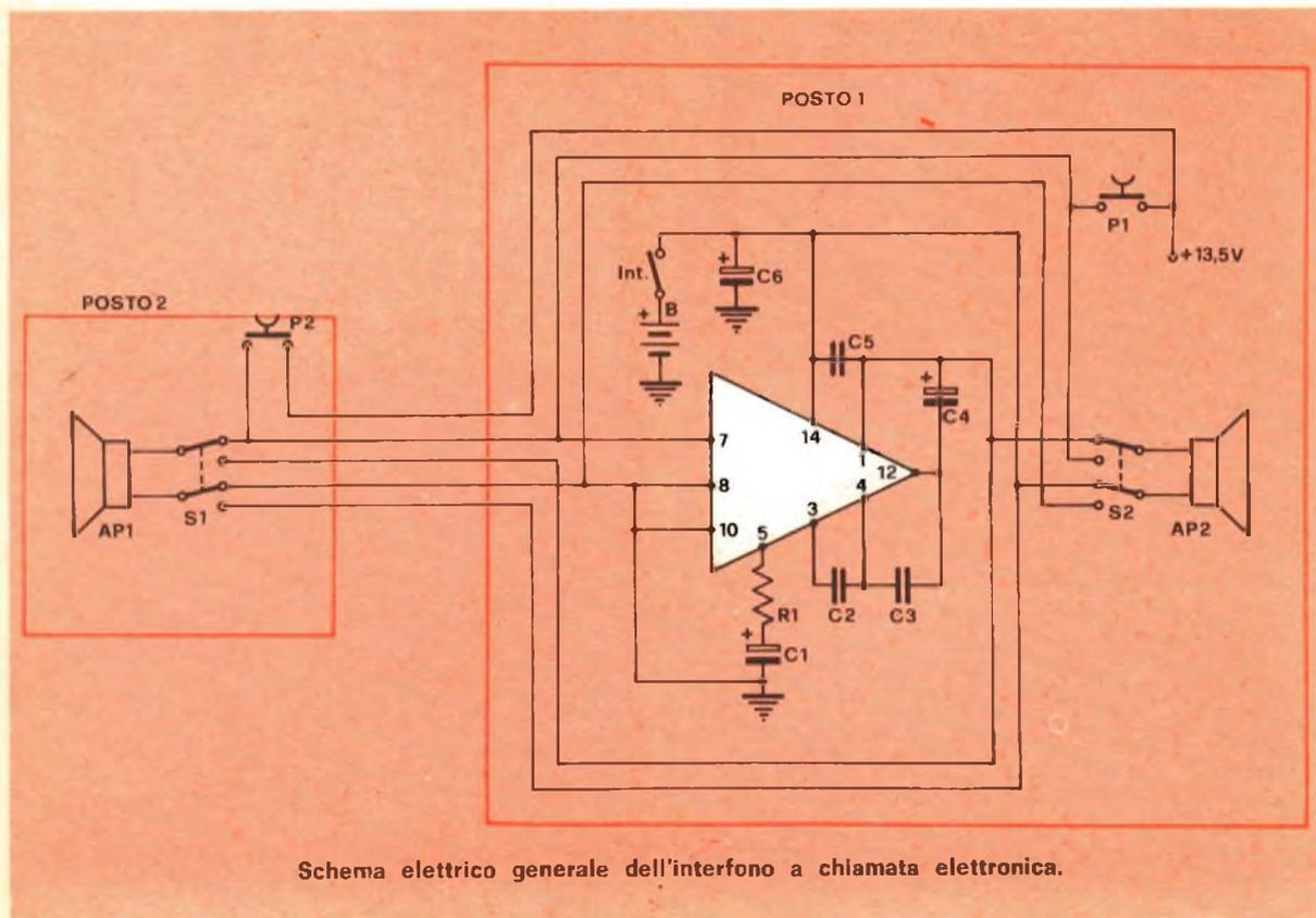
**Schema elettrico generale dell'interfono a chiamata elettronica.**
