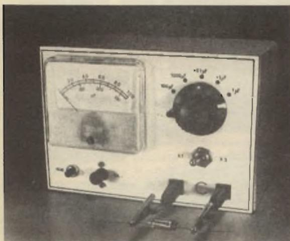
Il capacimetro in funzione. Il sistema di ancoraggio a coccodrilli danneggia il meno possibile i reofori, o terminali dei condensatori in prova. Non funziona con gli elettrolitici.
