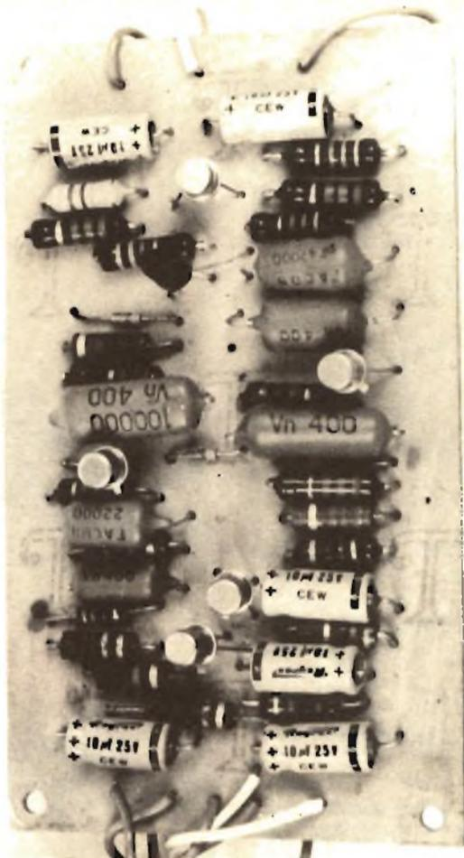
Gli appassionati della miniaturizzazione possono ridurre ulteriormente le dimensioni del prototipo progettando uno stampato previsto per il montaggio in verticale delle resistenze e dei condensatori.
