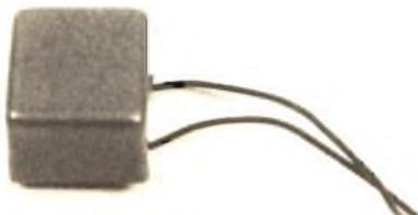
La spia telefonica da installare nell'interno dell'apparecchio.
