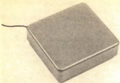
Questo modello di microfono d'ambiente, grande poco più di una scatola di cerini può captare e ritrasmettere quanto viene detto nel locale sotto controllo.
