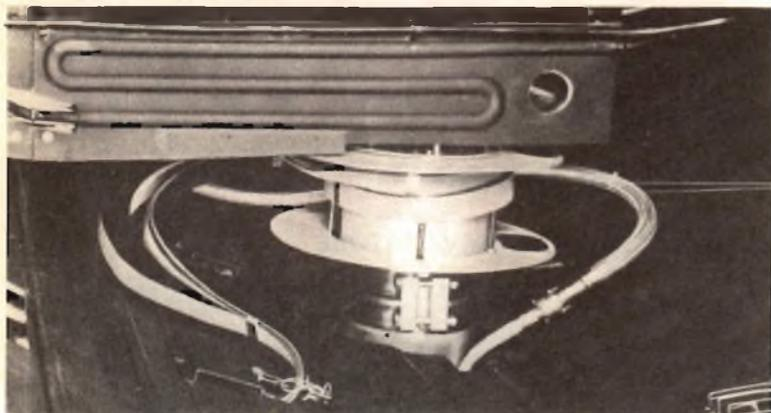
È stata costruita in Europa una camera di simulazione di orbita spaziale munita di depressori ad ambo i lati. Un simulatore solare, installato nel basamento, genera una radiazione pari a quella del sole che viene riflessa mediante uno specchio a mosaico sistemato nella parte posteriore della camera. Il satellite viene collocato in una culla regolabile, per simulare l'inclinazione dell'oggetto da collaudare rispetto al sole. La pittura nera termoas-
