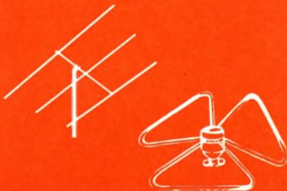
se volete fare collegamenti a lunga distanza, un'antenna direttiva a più elementi determina sicuramente la condizione migliore per la trasmissione. In commercio esistono i più svariati modelli di antenne per cui non vi resta altro da fare che scegliere la vostra, ricordandovi però che deve necessariamente essere accordata sui 144 MHz.
