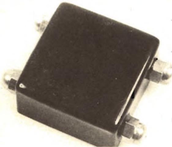
A differenza del semplice fusibile il corpo della emittente a modulazione di frequenza è costituito da una scatola cui sporgono i terminali dei due fusibili e dove è situata una vitina per la taratura della frequenza nello spettro compreso fra 88 e 108 MHz. L'emittente è individuabile quindi, con un po' più di difficoltà del semplice fusibile ma non si può certo dire che sia cosa impossibile.
