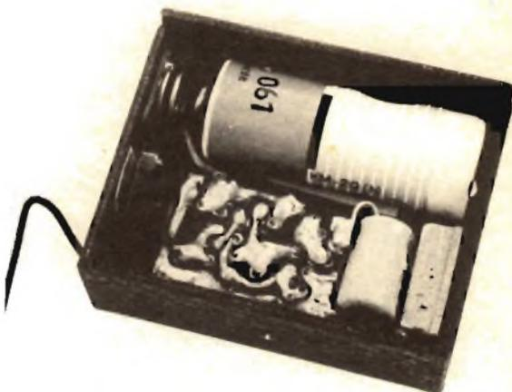
Trasmittente a frequenza fissa racchiusa in un fusibile telefonico.
