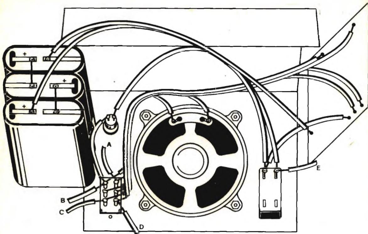
I conduttori di collegamento fra le due unità possono essere convenientemente sostituiti da un cavo a più conduttori isolati.
