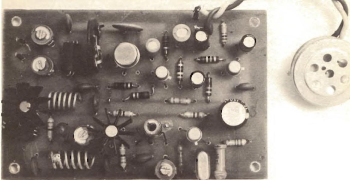
cole resistenze da 1/4 di watt negli appositi fori. Le resistenze, dopo essere state accuratamente selezionate in base al codice dei colori, sono pronte per la piegatura dei terminali. Come ciascuna resistenza è sistemata nella giusta posizione si può procedere all'operazione di fissaggio con il saldatore. Cosa importante è saldare i resistori prima di tagliare i reo-
