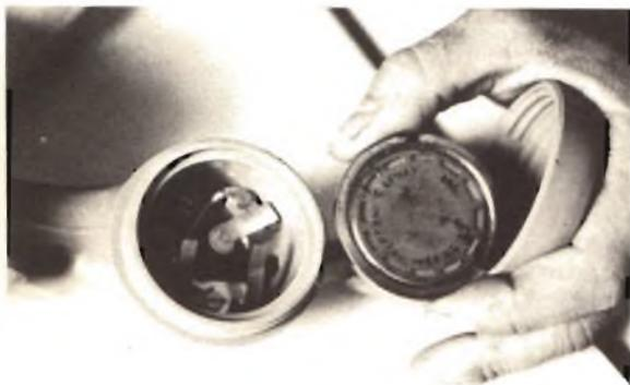
L'inserimento della capsula è cosa di pochi secondi: si svita, si leva la capsula, la si sostituisce e si richiude. L'alimentazione viene prelevata dalla linea telefonica.
