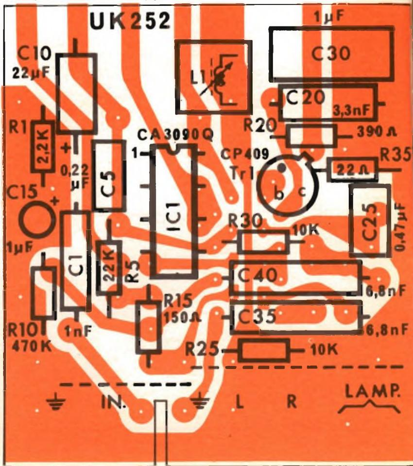
— Inserire e saldare i due ponti indicati sulla figura con due linee tratteggiate. Vediamo ora le operazioni di base per il montaggio.
