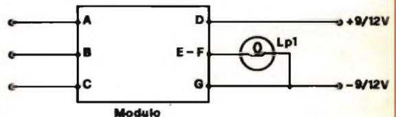
Lp1 = lampadina da 9 V/50 mA oppure diodo emettitore di luce (LED).
