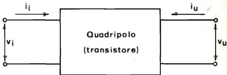
Il transistor, considerati i suoi parametri, può essere trattato nella sua struttura equivalente, ad esempio un quadripolo.
