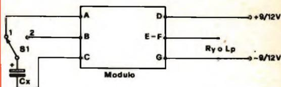
**CX** = condensatore elettrolitico con valore compreso fra 10  $\mu\text{F}$  e 1000  $\mu\text{F}$  (o oltre) 12 V.
