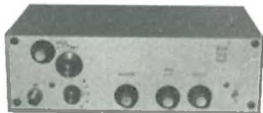
Radoricevitori e telaietti monobanda e multibanda VHF - AM - FM - CW. Ricevono oltre i normali programmi radio e TV, le gamme marine, soccorsi stradali, ponti radio, aerei, CB, radioamatori, telegoniometriche, ecc.
