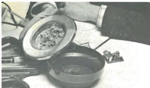
La piccolissima capsula microfonica si presenta per essere nascosta con la massima facilità, ad esempio nell'interno di un posacenere.
