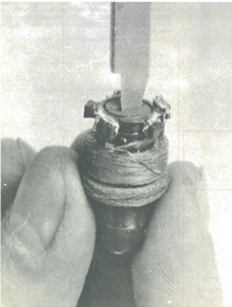
dei trasformatori di media frequenza; una a punta rettangolare per gli accordi muniti di nucleo da  $\varnothing$  6 mm, una quadra o esagonale per nuclei più grandi e via di seguito.
