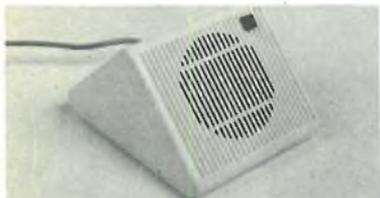
Progetto per la costruzione di un generatore elettronico di ozono. Le proprietà chimiche di questo gas fanno sì che l'apparecchio sia ospite gradito in ogni stanza dove sia necessario purificare l'aria.
