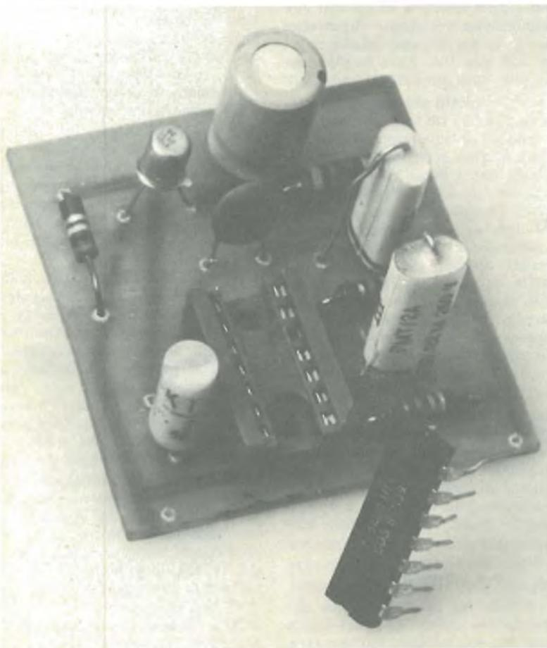
terminali sono facilmente identificabili essendo disposti nel più classico dei modi. Per la saldatura di questo componente valgono gli stessi suggerimenti dati a proposito della saldatura dell'integrato.
