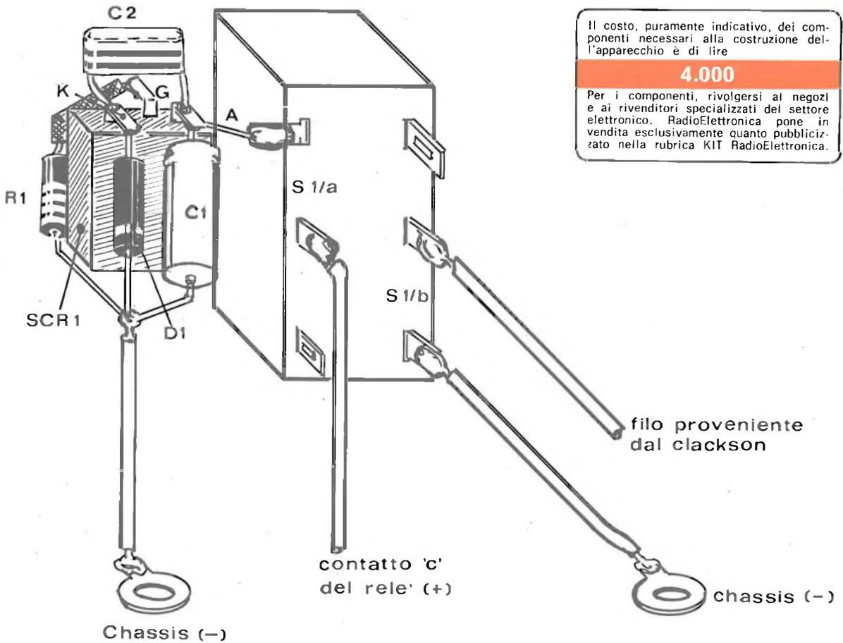
Il montaggio dell'apparecchio è stato eseguito con la tecnica del cablaggio « in aria ». Gli elementi utilizzati sono così limitati che si raccolgono senza difficoltà intorno al corpo dell'interruttore.
