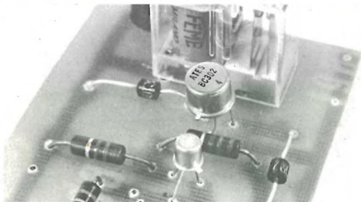
primo transistor. Il relé si dovrà eccitare e dovrà rimanere in questo stato fino a quando non si provvederà a togliere il dito. Se ciò non si verificasse, controllate la tensione di emettitore di TR2 e TR3 che deve mantenersi ad un livello costante sia con relé eccitato che con relé a riposo.
