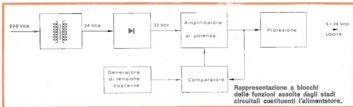
**Schema elettrico generale. L'impiego di strumenti di misura all'uscita dell'alimentatore permette di verificare le condizioni di funzionamento in ogni istante.**
