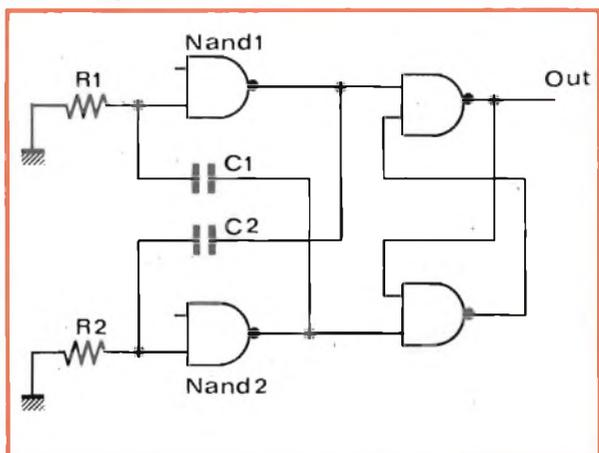
L'integrato SN 7400 è l'elemento attivo del generatore di bassa frequenza. Nel disegno in alto è raffigurata la disposizione tipica dei terminali, ai piedini 7 e 14 si applica la tensione di alimentazione.
