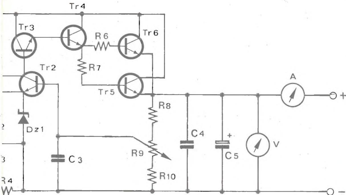
del cursore del potenziometro ovvero della tensione di base. Essendo i transistori TR3 TR4, TR5 e TR6 in conduzione, la tensione di uscita è pressoché identica alla tensione di collettore di TR3 a meno delle cadute di tensione tra base ed emettitore di TR3, TR4, TR5 e TR6.
