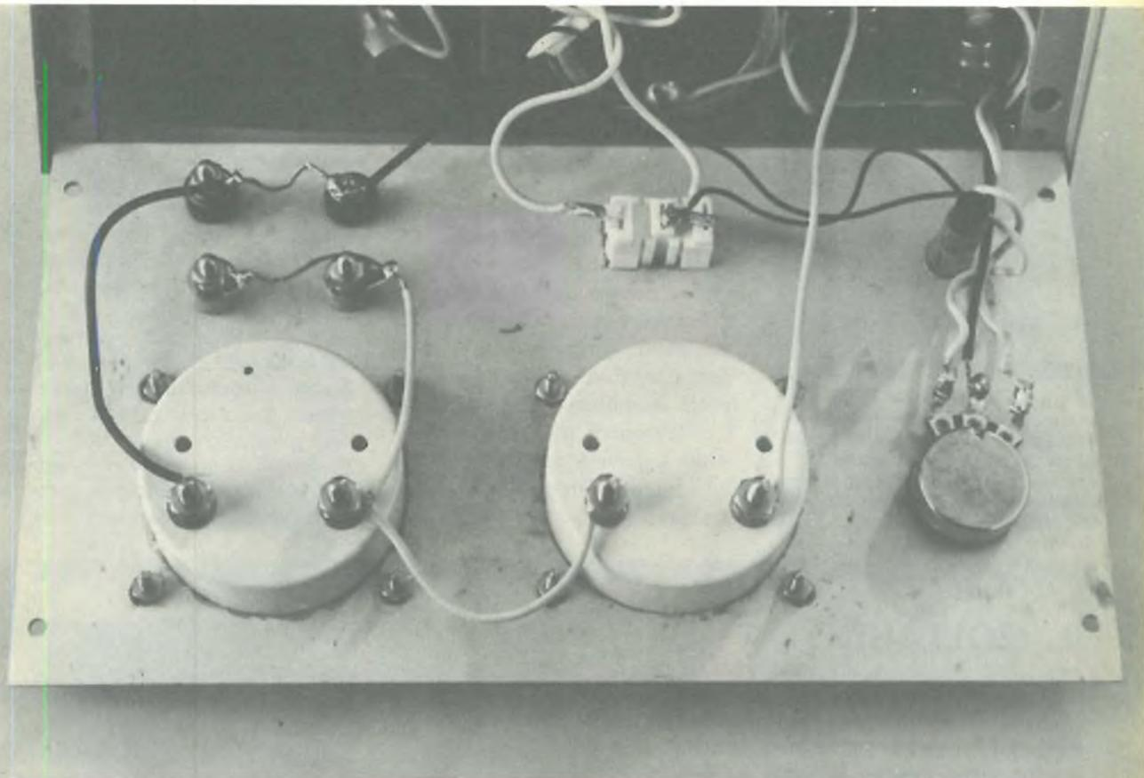
**Vista d'insieme del retro del pannello frontale dell'apparecchio su cui sono fissati gli strumenti, il comando di regolazione di tensione, la spia luminosa, l'interruttore e le boccole di uscita.**
