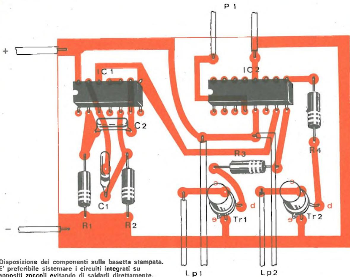
Disposizione dei componenti sulla basetta stampata. E' preferibile sistemare i circuiti integrati su appositi zoccoli evitando di saldarli direttamente.
