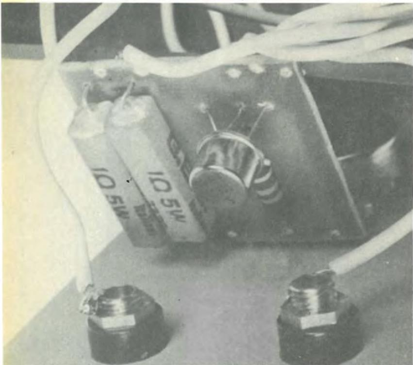
**Basetta posta all'interno del contenitore. Sul piano del supporto ramato, oltre al transistor utilizzato, sono sistemati i resistori fra cui due elementi di potenza.**
