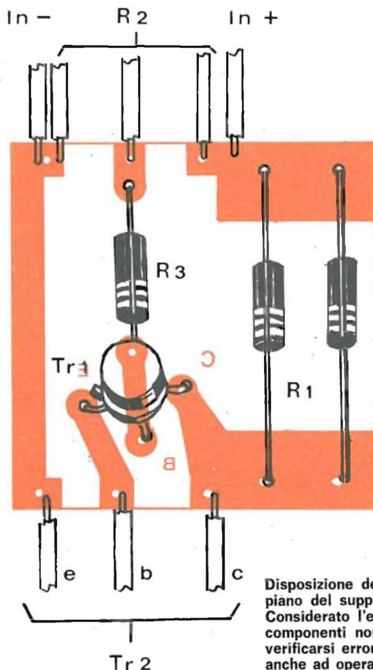
Disposizione dei componenti sul piano del supporto ramato. Considerato l'esiguo numero di componenti non dovrebbero verificarsi errori di montaggio anche ad opera dei più inesperti.
