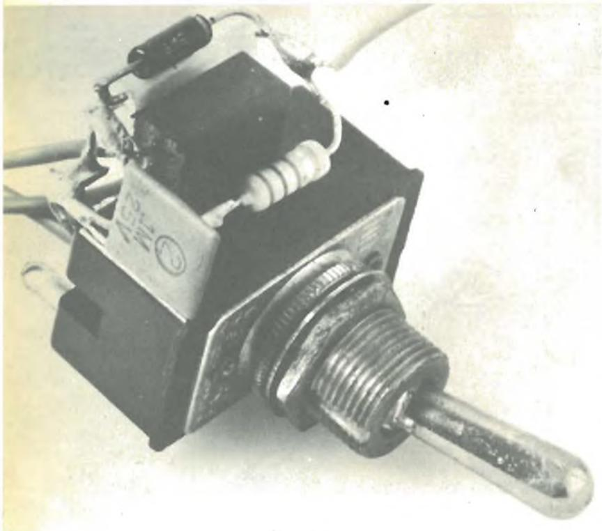
**Prototipo del dispositivo antifurto utilizzato per condurre le sperimentazioni. Eseguendo il cablaggio « in aria » si consiglia di prestare molta attenzione a che i terminali dei componenti non creino contatti accidentali.**
