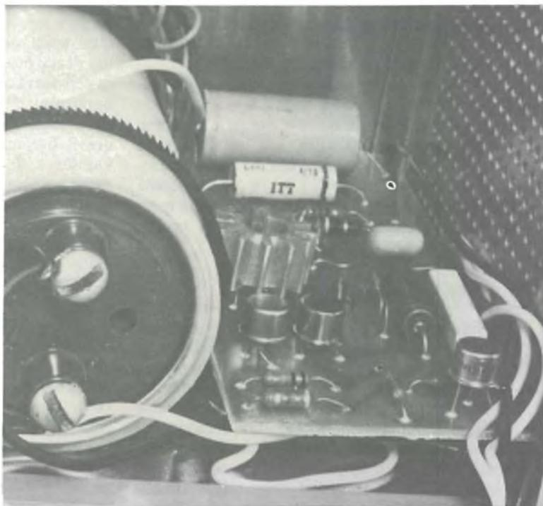
Particolare del prototipo in cui si nota la basetta fissata al contenitore. Come si può vedere il transistor TR4 è stato munito di dissipatore termico: una buona precauzione per assicurare un corretto funzionamento.
