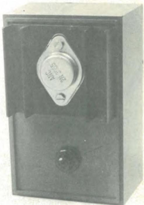
tore di carico (e quindi anche il dissipatore) in una scatoletta metallica, è opportuno che il transistor di potenza ed il dissipatore siano isolati fra loro; a tale proposito, occorre inserire una lamina di mica fra il transistor di potenza ed il dissipatore. Inoltre, le viti necessarie per serrare il transistor dovranno essere munite di passanti isolanti. E' anche opportuno, al fine di permettere una migliore trasmissione del calore fra il transistor ed il dissi-
