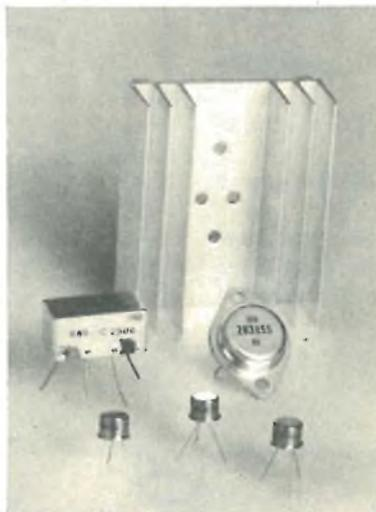
Semiconduttori utilizzati per la costruzione del dispositivo. Al dissipatore termico sarà fissato il transistor finale tipo 2N3055.
