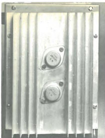
La coppia di transistor finali impiegati nel progetto devono necessariamente essere sistemati su di un capace dissipatore termico che ne garantisca la stabilizzazione delle caratteristiche nel tempo.
