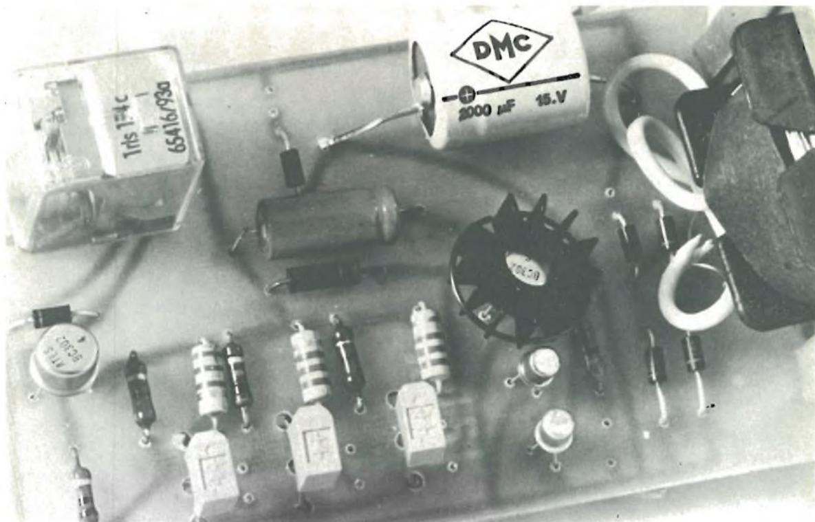
Come potete vedere dall'immagine Q3 è l'unico semiconduttore che necessita di un dissipatore termico. Il suo fissaggio richiede solo pochi istanti.
