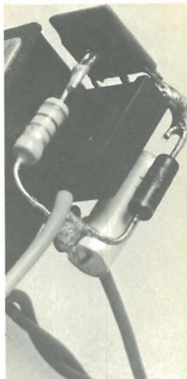
**Particolare del montaggio. L'inversione di uno dei terminali dei componenti polarizzati impedirebbe il funzionamento. Si raccomanda quindi di verificare accuratamente il montaggio prima di eseguire l'installazione e il collaudo.**
