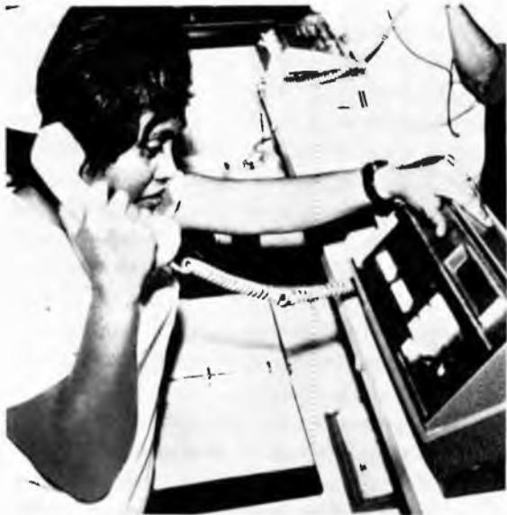
*Una centrale telefonica per le infermiere (in primo piano a sinistra) trasmette una comunicazione telefonica fra una sala dell'infermeria e il paziente.*
