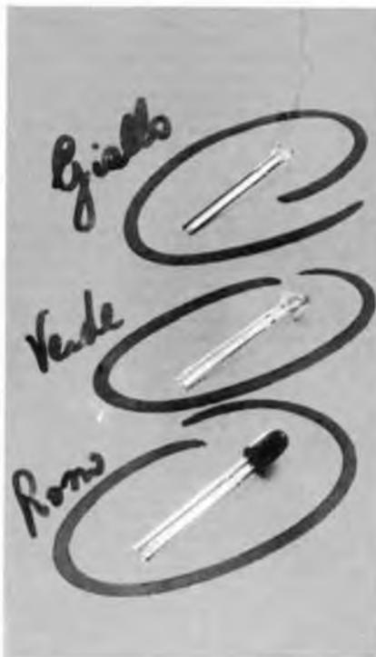
Nel campo dei componenti la Divisione Semiconduttori della ITT produce ora tre diodi luminosi di colore rosso, verde e giallo.
