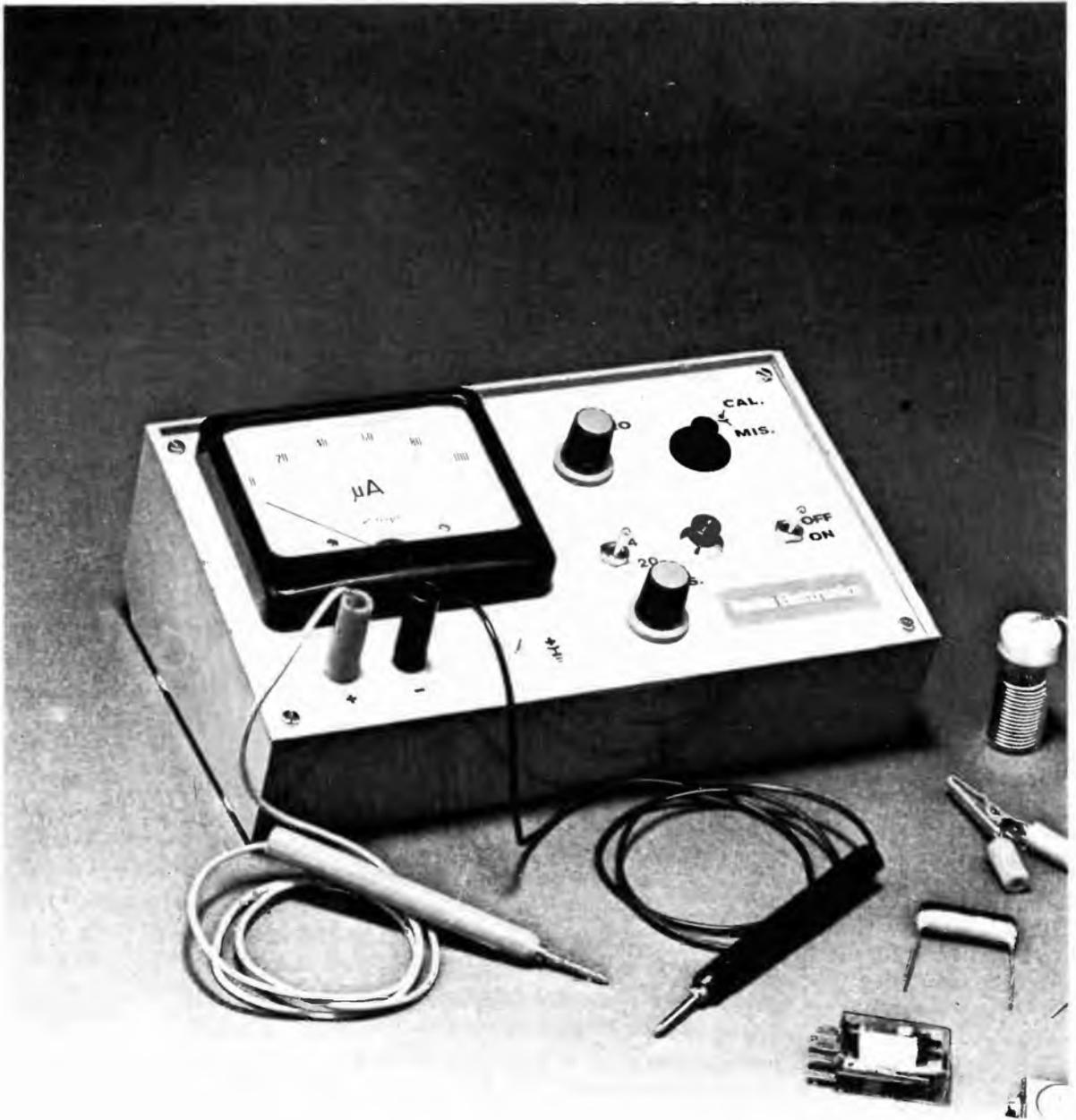
Un progetto per completare le proprie strumentazioni di misura. Altissima impedenza d'ingresso con circuito di calibrazione controllato mediante diodi zener: l'ampia scala di misura dello strumento indicatore adottato consente di ottenere una elevata risoluzione di misura sulle due portate per il cui il circuito è stato tarato.
