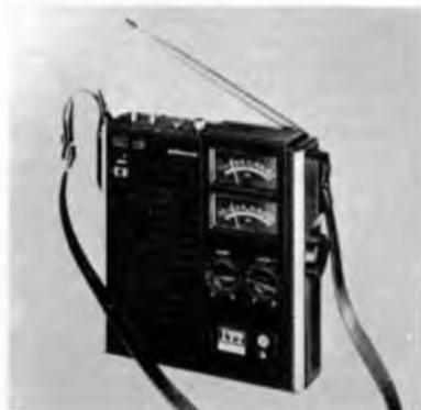
sulle FM, di 2 scale a presentazione professionale e di 2 antenne incorporate. Peso con batterie 1,3 kg.
