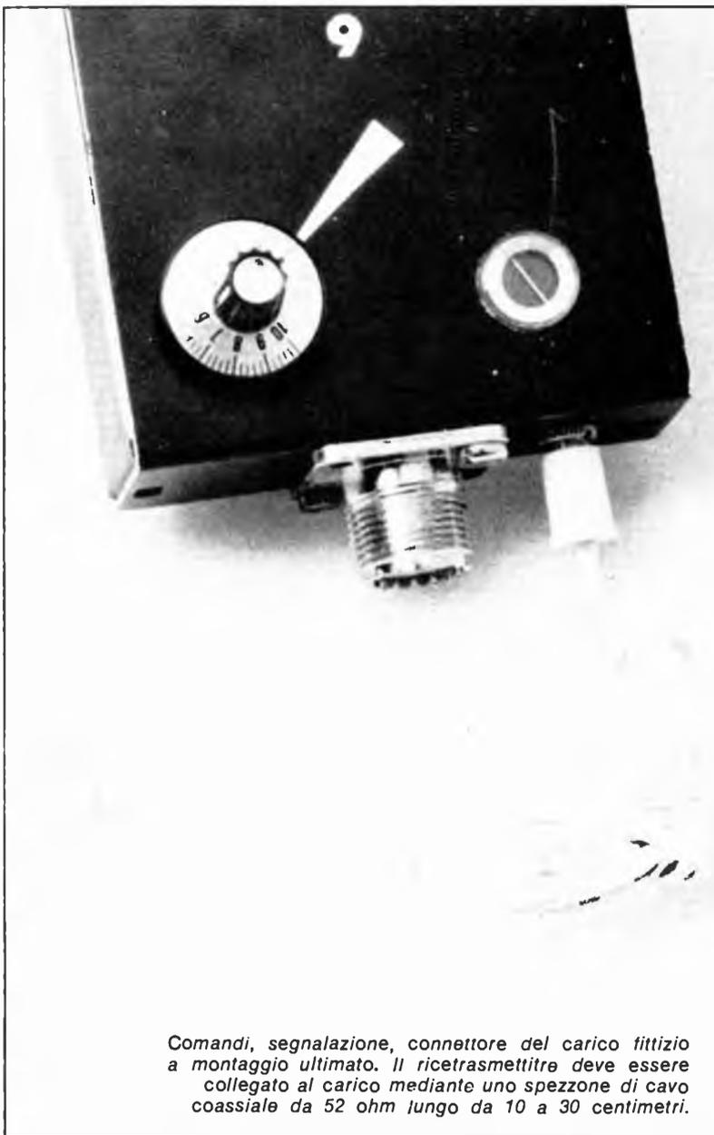
*Comandi, segnalazione, connettore del carico fittizio a montaggio ultimato. Il ricetrasmittente deve essere collegato al carico mediante uno spezzone di cavo coassiale da 52 ohm lungo da 10 a 30 centimetri.*
