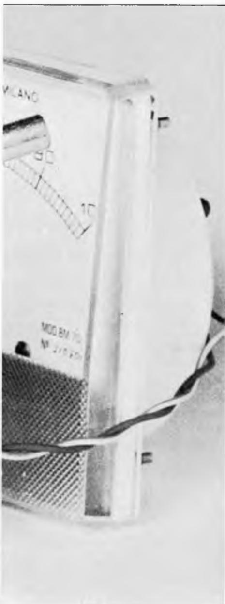
Con il frequenzimetro qui descritto possono essere misurate frequenze da 10 Hz a 100 KHz. L'indicazione avviene direttamente su uno strumento a bobina mobile (milliamperometro con una deviazione totale di 1 mA). Sono previste quattro portate, in modo da ottenere una buona ed esatta precisione di lettura. Il passaggio tra le varie portate avviene mediante un commutatore multiplo a 4 posizioni; la gamma di frequenza misurabile con questo frequenzimetro è suddivisa come segue:
