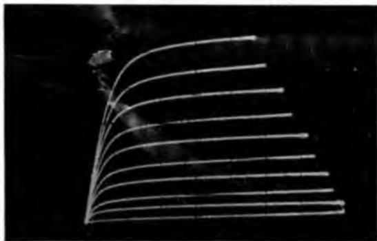
tre il 6° gradino, le curve si restringono sensibilmente, ciò che si traduce in un'elevata non linearità del guadagno. Non si può quindi raccomandare questo transistor per delle utilizzazioni in cui si richieda una amplificazione lineare per una corrente di collettore superiore a 30 mA.
