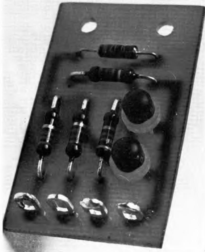
*Basetta del circuito base a montaggio ultimato. Quanto da noi proposto è solo un esempio di costruzione, nel caso che l'utilizzazione sia ad esempio quella di indicatore stato delle batterie, il circuito può essere facilmente miniaturizzato e riposto nello stesso contenitore dell'apparecchio con cui viene utilizzato*
