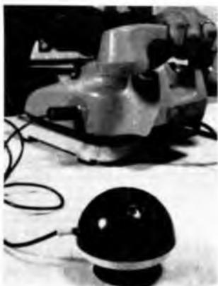
Un apparecchio quasi straordinario: riceve in altoparlante le trasmissioni radio o a volontà amplifica i deboli segnali telefonici. Il circuito del ricevitore è a circuito integrato, con bobina in ferrite, comando sintonia e potenziometro di volume. Con un captatore telefonico, che viene fornito già bell'e pronto, si possono amplificare le comunicazioni dal telefono.
