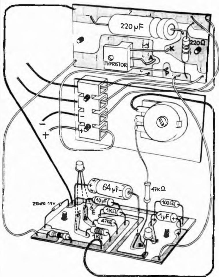
*Esplso di montaggio del dispositivo realizzato mediante il sistema delle due basette miniaturizzate. Si raccomanda particolare attenzione a questa figura durante l'esecuzione del cablaggio tra le parti.*
