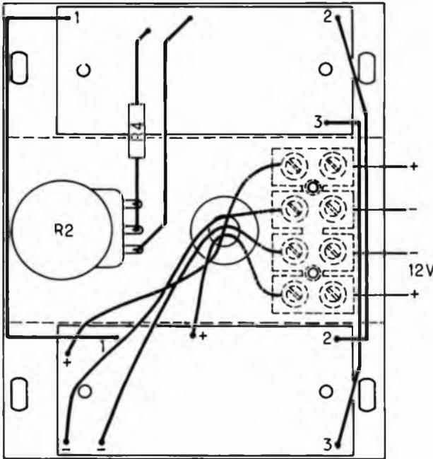
*Nel disegno sopra riportato sono evidenziati i rapporti di collegamento esistenti fra le basette e la morsettiera da cui si dipartono i fili per il collegamento all'alimentazione ed al motorino del tergicristallo.*
