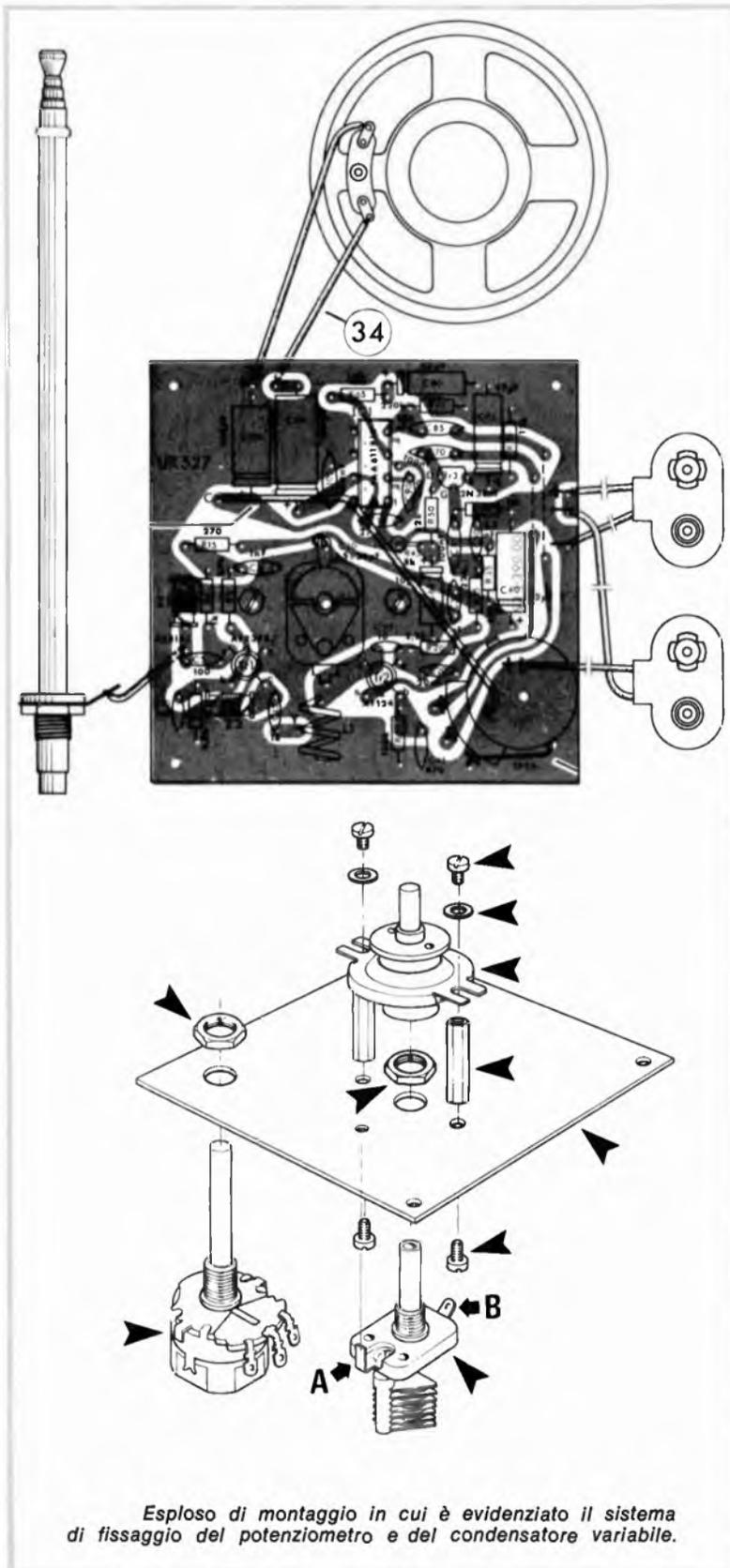
Esplso di montaggio in cui è evidenziato il sistema di fissaggio del potenziometro e del condensatore variabile.
