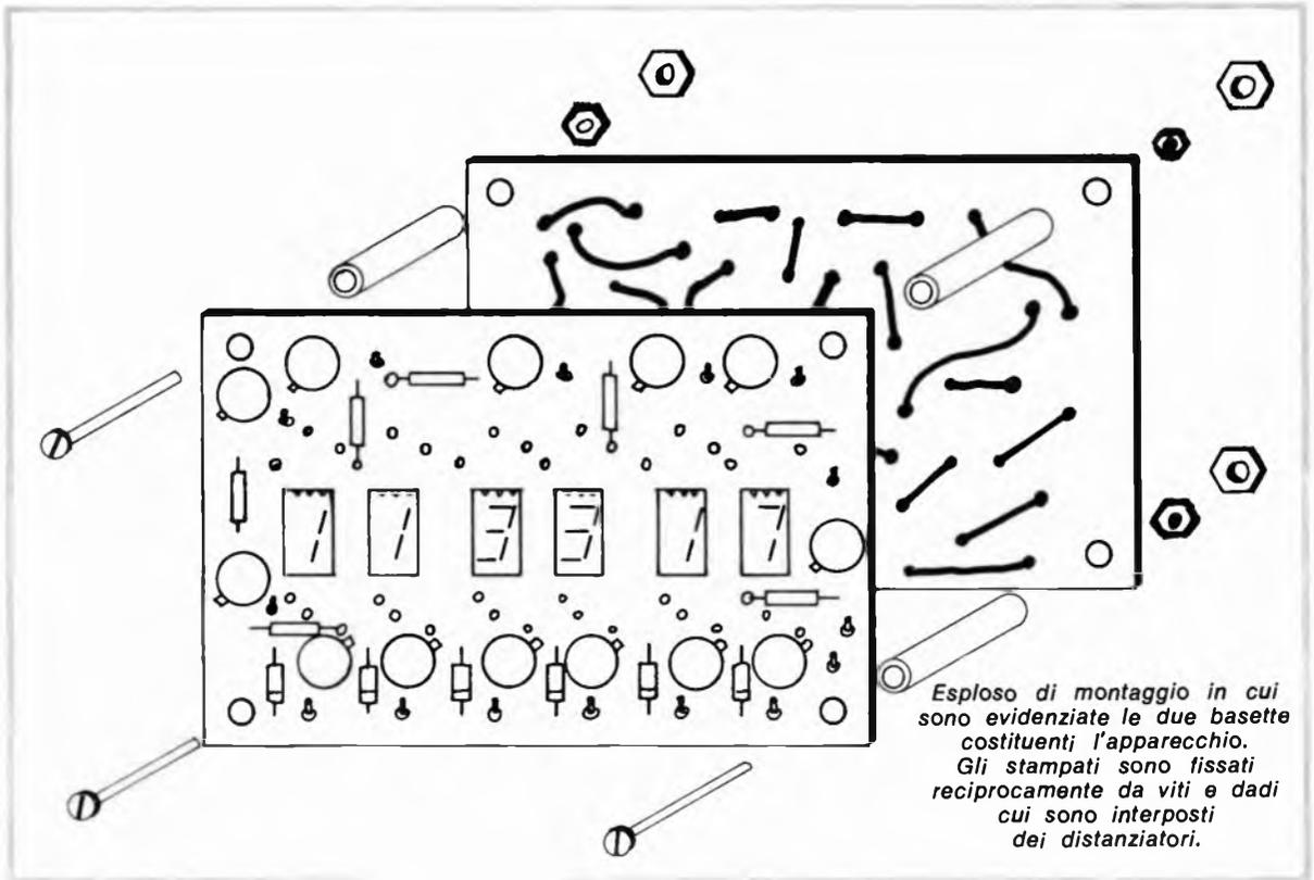
*Esplso di montaggio in cui sono evidenziate le due basette costituenti l'apparecchio. Gli stampati sono fissati reciprocamente da viti e dadi cui sono interposti dei distanziatori.*
