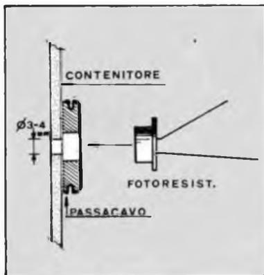
*Esempio per la sistemazione degli elementi fotoresistivi al contenitore destinato a celare il gadget elettronico. Nella foto, l'apparecchio completo. L'alimentazione è ottenuta mediante una pila per transistor da 9 volt.*
