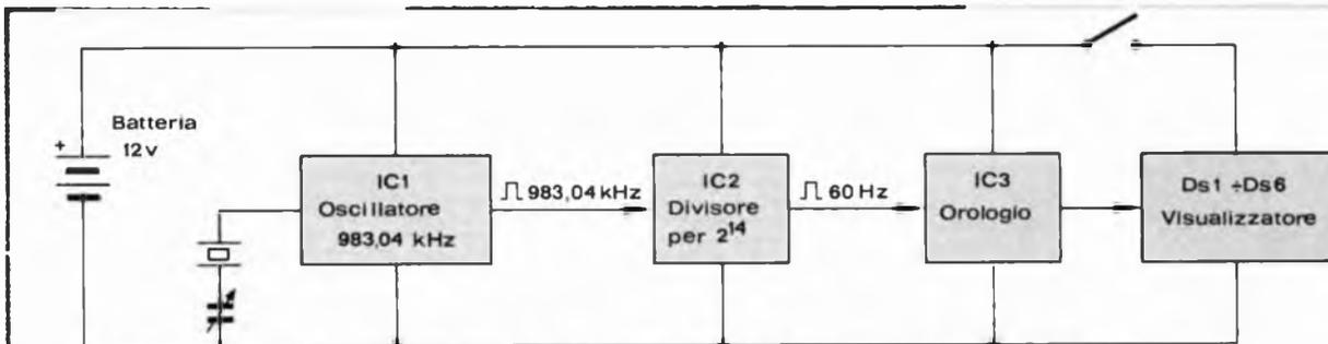
Schema a blocchi dell'orologio con alimentazione a 12 volt e controllo di frequenza a quarzo.
