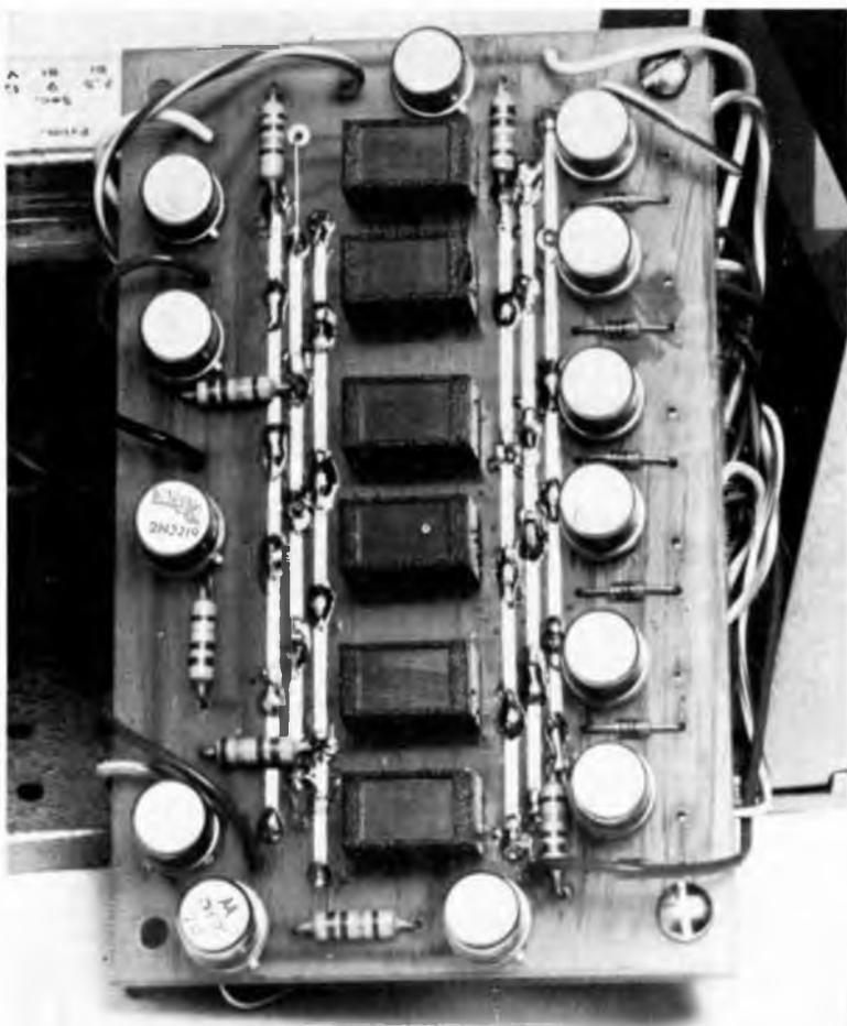
*Anche la basetta della sezione per la visualizzazione numerica, come quella dell'unità base costituente l'orologio, è realizzata in doppia traccia. Nella coppia di pagine sono riprodotti i piani in dimensione naturale per realizzare entrambi i lati della basetta del visualizzatore.*
