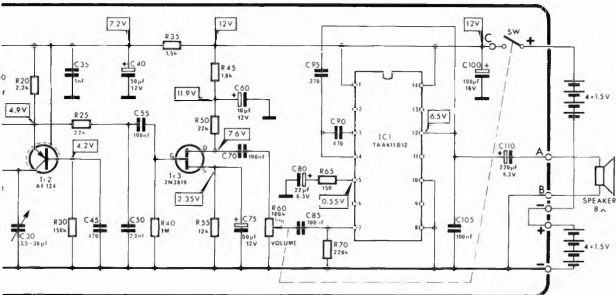
Schema elettrico del ricevitore per la gamma VHF. La sezione di alta è di tipo superreattivo mentre il compito di amplificare il segnale di bassa frequenza è assolto dal circuito integrato TAA 611B12.
