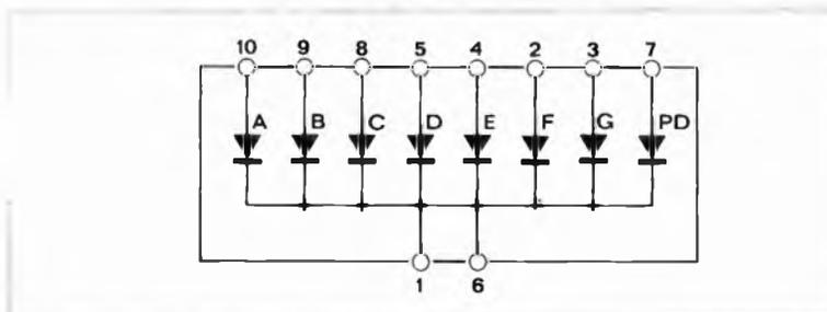
Per la visualizzazione sono impiegati display tipo FND70; Nei disegni sono riportati i termini per l'identificazione delle connessioni.
