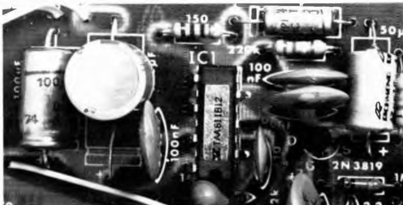
presenta un'ottima prestazione dovuta all'impiego di un FET al primo stadio, il quale riduce il rumore della amplificazione, e di un circuito integrato che ha delle prestazioni non ottenibili che con circuiti molto complessi. L'alimentazione dell'UK 527 avviene mediante 8 pile da 1,5 V incorporate, per cui l'apparecchio è facilmente trasportabile e sempre pronto per l'uso.
