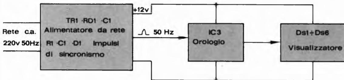
Orologio con alimentazione a 220 volt e controllo di frequenza tramite rete elettrica.
