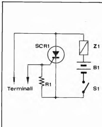
te da quattro elementi. Quando i due terminali vengono immersi nell'acqua, per effetto della discreta conducibilità di questa sostanza allo stato non puro, attraverso il gate fluisce una corrente sufficiente a fare entrare in conduzione il diodo controllato. Ciò determina anche l'allarme che è costituito da un cicalino o da una piccola sirena. La tensione di alimentazione del circuito deve essere simile alla tensione nominale di funzionamento di quest'ultimo elemento.
