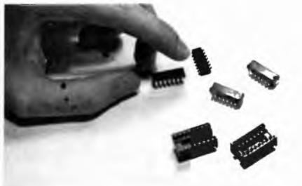
*I circuiti integrati sono molto sensibili alla temperatura. Per evitare di saldarli possono essere impiegati appositi supporti.*
