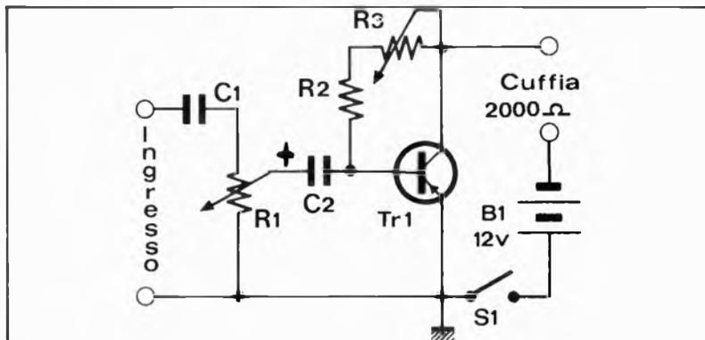
sentato dal potenziometro R1, serve a regolare il livello del segnale di ingresso per evitare che un segnale di ampiezza eccessiva possa danneggiare il dispositivo; il secondo è impiegato per ridurre al minimo la distorsione. La tensione di alimentazione può essere compresa tra 9 e 12 Volt.
