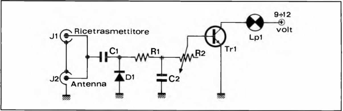
st'ultimo caso è necessario impiegare per i collegamenti con il baracchino e l'antenna due connettori coassiali.
