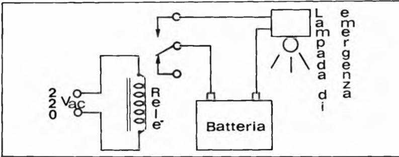
L'improvvisa mancanza di energia elettrica può provocare in alcuni casi gravi inconvenienti che possono essere evitati con un impianto di emergenza — del tipo di quello qui descritto — che entra in funzione automaticamente non appena la tensione di rete manca.
