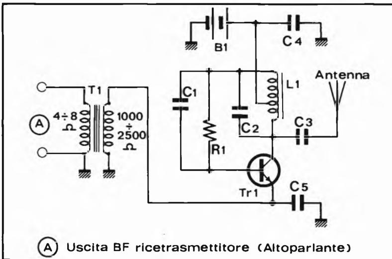
racchino. Il trasformatore di modulazione collegato in serie all'emettitore del transistor è un piccolo trasformatore di uscita per amplificatori di BF. Il circuito oscillante è di sicuro funzionamento; con uno spezzone di conduttore della lunghezza di alcuni metri in funzione di antenna la portata è di alcune decine di metri. La tensione di alimentazione può essere fornita da una batteria miniatura da 9 volt.
