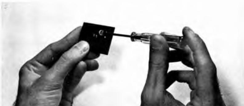
*I trimmer possono avere diverse misure. Per una rapida regolazione è bene disporre di cacciaviti con lame di svariate dimensioni.*
