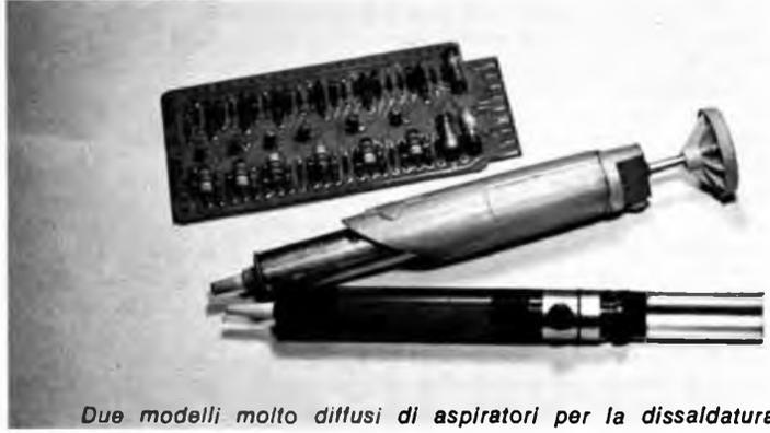
Due modelli molto diffusi di aspiratori per la dissaldatura.
