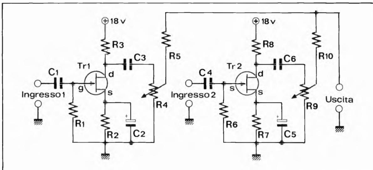
Questo miscelatore-preamplificatore a due canali è stato studiato per essere impiegato con apparecchiature professionali; esso, infatti, offre delle prestazioni veramente notevoli. Questo dispositivo è in grado di amplificare e miscelare i segnali prodotti da due microfoni ad
