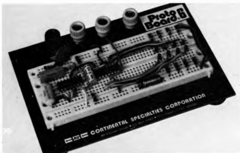
Questo preamplificatore microfonico pur utilizzando solamente un circuito integrato e pochi altri componenti passivi fornisce un guadagno in tensione di ben 60 dB (1000 volte) e produce un rumore di fondo talmente basso che il rapporto segnale disturbo supera i 100 dB. Per evitare di saturare il preamplificatore, l'ampiezza del segnale di ingresso non deve superare i 7 millivolt. L'impedenza nominale di ingresso è di 47
