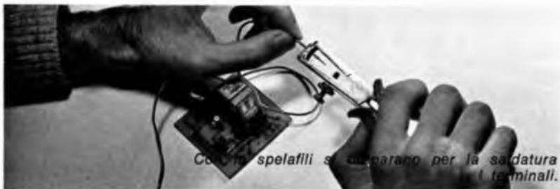
*Con gli spelafili si preparano per la saldatura i terminali.*
