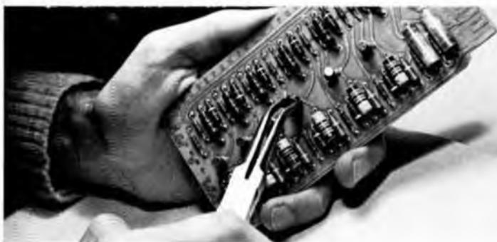
*Talvolta la fonte di componenti per gli sperimentatori sono le schede surplus. Per non danneggiare le parti durante il recupero si debbono impiegare attrezzi di foglia idonea: nell'immagine una pinzetta con attacco per l'estrazione dei transistor.*
