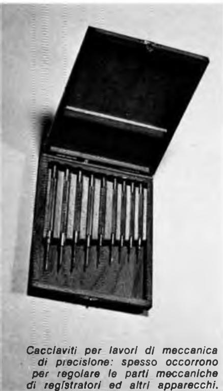
*Cacclaviti per lavori di meccanica di precisione: spesso occorrono per regolare le parti meccaniche di registratori ed altri apparecchi.*
