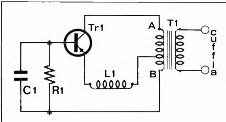
Questo semplicissimo circuito è un monitor per trasmissioni telegrafiche che non richiede alcun collegamento per funzionare e neppure una batteria di alimentazione. E' infatti sufficiente avvicinare la bobina L1 al bocchettone di uscita del trasmettitore per ottenere un segnale di ampiezza sufficiente a pilotare la cuffia. Il segnale viene anche amplificato da un transistor la cui alimentazione è ottenuta dal segnale stesso. La bobina L1 è composta da
