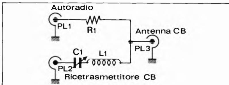
Il circuito qui descritto consente l'impiego contemporaneo in automobile di un'autoradio e di un ricetrasmittitore CB utilizzando una sola antenna esterna. In questo modo si evita di forare la carrozzeria in due punti e si ottiene un indubbio vantaggio economico. Il principio di funzionamento di questo dispositivo è molto semplice. L'antenna esterna è una comune antenna CB da automobile;
