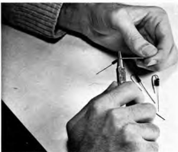
Con una pinzetta a becchi tondi si possono piegare i terminali delle resistenze prima del loro montaggio.
