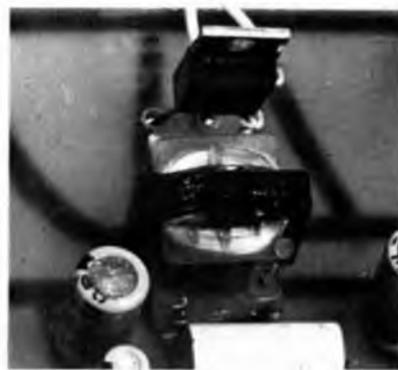
quello utilizzato nel generatore monocanale. Anche i tre TRIAC sono dello stesso tipo per cui la potenza massima delle lampade che possono essere collegate alle tre uscite ammonta a 6.000 Watt (3 x 2.000 W). E' consigliabile collegare in serie ad ognuna delle tre uscite un fusibile da 15 A per evitare che, in seguito ad accidentali corto circuiti, i TRIAC vengano distrutti.
