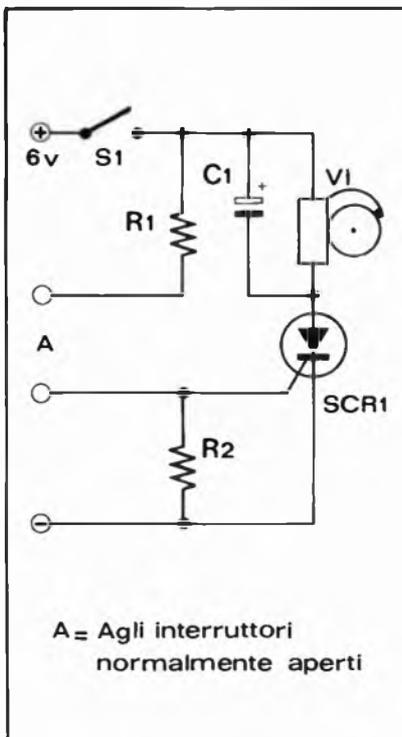
Al posto del cicalino o unitamente ad esso (collegata in parallelo) potrà essere impiegata una lampadina da 6 Volt. La alimentazione è fornita da quattro pile da 1,5 Volt collegate in serie. Per disinserrire l'allarme è sufficiente azionare l'interruttore S1.
