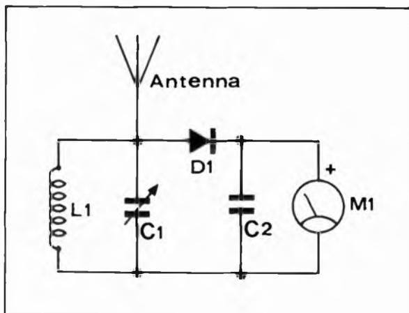
Anche senza fare ricorso a circuiti di amplificazione si può realizzare un misuratore di campo molto sensibile. A tale fine è sufficiente che il circuito di sintonia sia accordato sulle frequenze del trasmettitore in prova. Ciò significa che il condensatore del circuito di sintonia deve essere di tipo variabile; inoltre la bobina di AF dello stesso circuito deve poter esse-
