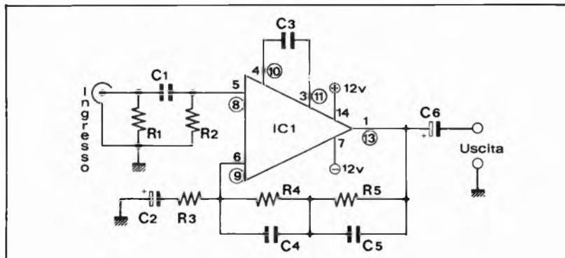
sono standardizzati per cui essi dovranno essere ottenuti collegando in serie o in parallelo diverse resistenze e condensatori. L'ingresso presenta una impedenza di 47 Kohm mentre la resistenza di uscita è di 10 Kohm.
