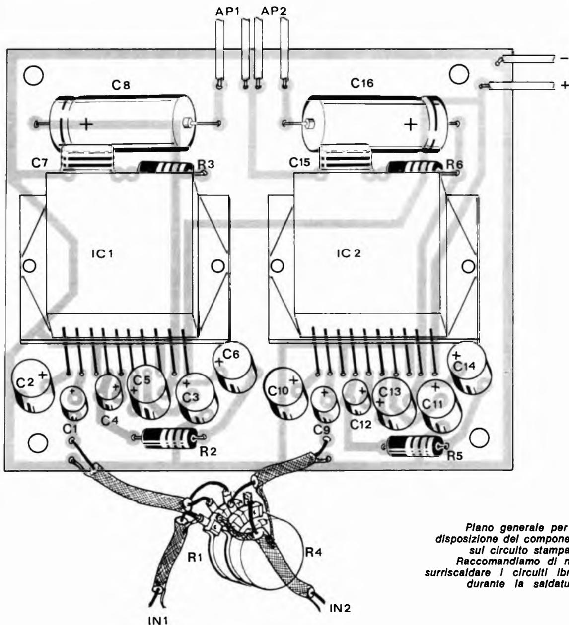
*Plano generale per la disposizione dei componenti sul circuito stampato. Raccogliamo di non surriscaldare i circuiti ibridi durante la saldatura.*
