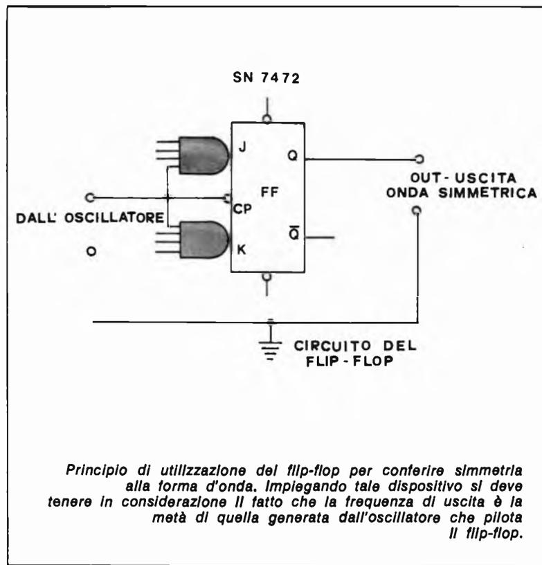
*Principio di utilizzazione del flip-flop per conferire simmetria alla forma d'onda. Impiegando tale dispositivo si deve tenere in considerazione il fatto che la frequenza di uscita è la metà di quella generata dall'oscillatore che pilota il flip-flop.*
