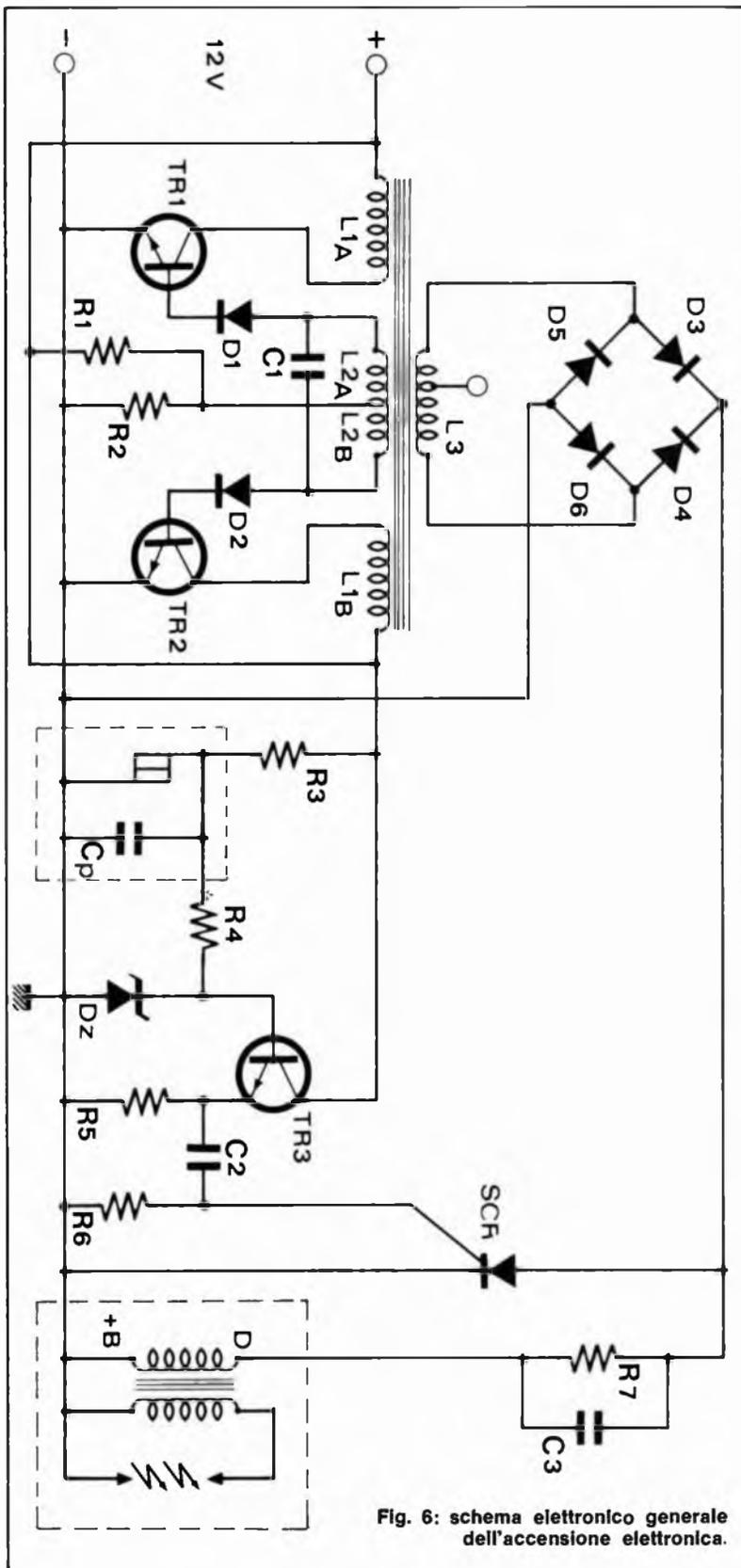
Fig. 6: schema elettronico generale dell'accensione elettronica.
