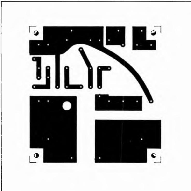
A sinistra, disposizione dei componenti sul circuito stampato. I terminali dei fili debbono essere connessi secondo il seguente codice: A, alla presa centrale dell'avvolgimento di collettore (+ 12 V); B, alla presa centrale dell'avvolgimento di reazione di base; C, al piedino 1 dello zoccolo noval; D; agli emettitori dei TR1 e TR2 (massa); E, al secondario del trasformatore; F, al secondario del trasformatore; G, alla bobina dell'auto.
