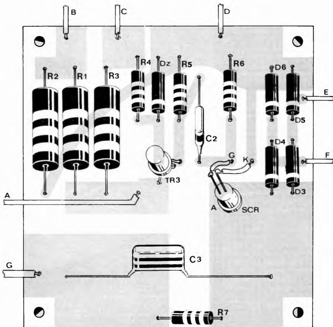
re V3 con la polarità normale. A questo punto essendo lo SCR interdetto cessano le oscillazioni di L con C3 e mentre quest'ultimo viene ricaricato a 400 V dal circuito elevatore di tensione, l'induttanza L1 dissipa la rimanente energia magnetica nelle oscillazioni smorzate con le sue capacità parassite.
