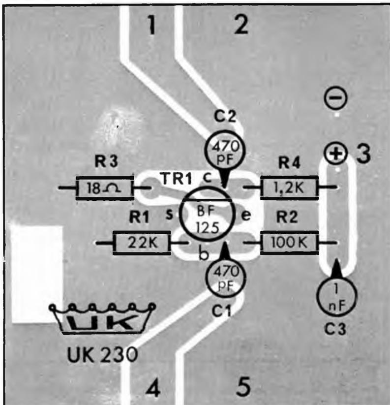
segnali che provengono da quest'ultima. Anche il condensatore C2, pure da 470 pF, assolve ad un compito simile a quello di C1. Esso blocca, infatti, la componente continua in modo che non si trasferisca verso il circuito di ingresso del ricevitore, mentre lascia passare i segnali di antenna amplificati verso il ricevitore stesso.
