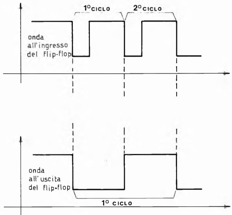
*Forme d'onda all'ingresso ed all'uscita del flip-flop. Osservando le rappresentazioni grafiche appare evidente che rispetto all'ingresso avviene una divisione di frequenza per due.*
