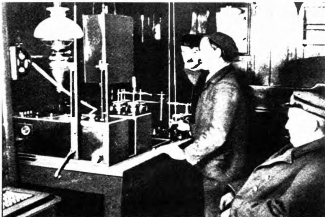
*Trasmittitore di cui ci si è avvalsi per la radiocronaca delle regate nel luglio del 1898.*
