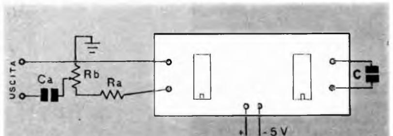
Modifiche da apportare al circuito per ottenere il controllo di ampiezza.  $R_a = 4,7 \text{ Kohm}$ ;  $R_b = 1 \text{ Kohm}$ ;  $C_a = 220 \text{ KpF}$ .
