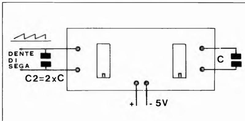
*Con l'inserzione di un solo condensatore di capacità doppia rispetto a C il generatore di onde quadre consente di ottenere in uscita una forma d'onda del tipo tecnicamente definito a dente di sega. Nel disegno, schema per l'inserzione del condensatore accessorio.*
