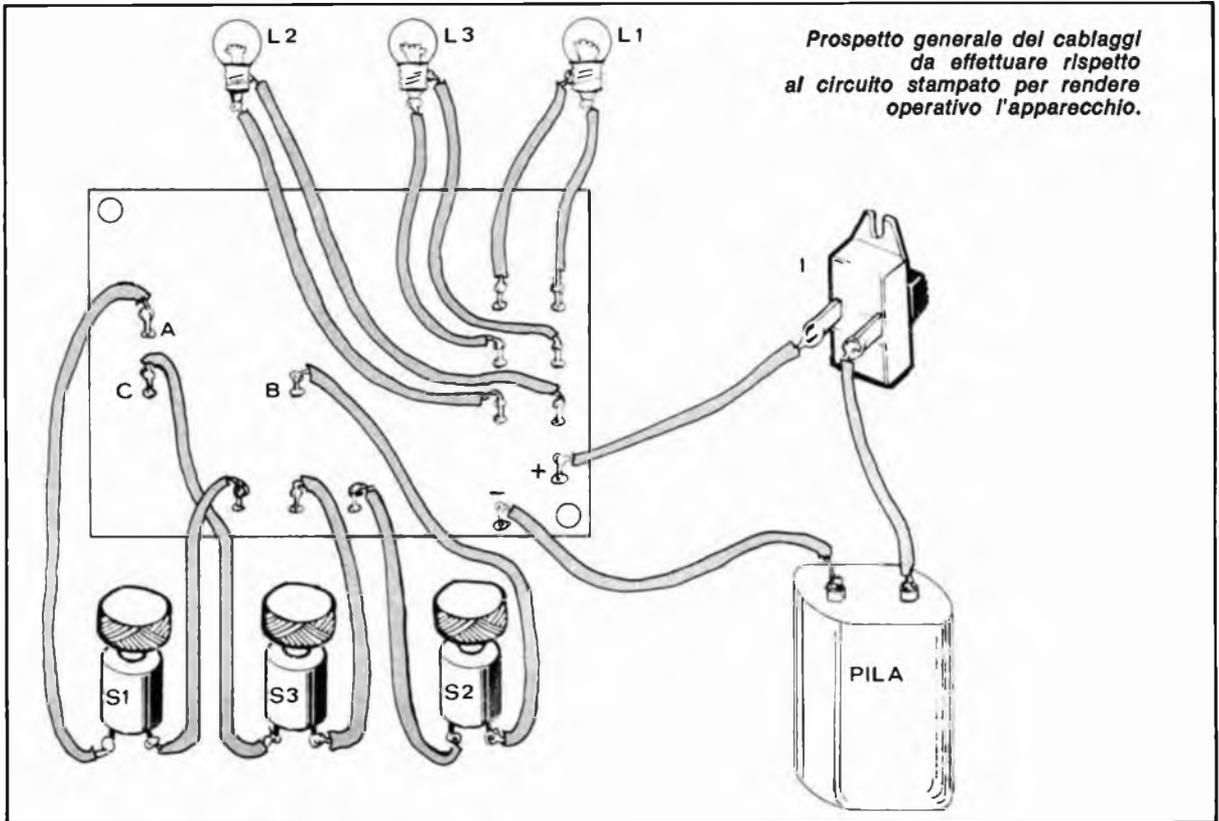
*Prospetto generale dei cablaggi da effettuare rispetto al circuito stampato per rendere operativo l'apparecchio.*
