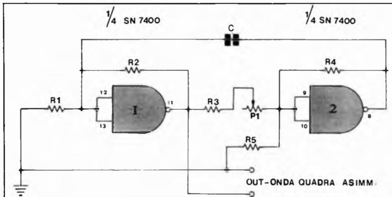
*Schema elettrico dell'oscillatore. La frequenza di oscillazione dipende dai valori di C e da P1. L'integrato SN 7400 contiene altre due porte NAND che non vengono utilizzate.*
