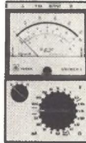
21-501 - UNIMER 3 - Analizzatore universale. Indispensabile al tecnico e all'hobbysta evoluto. Caratteristiche: Sensibilità 20.000 Ohm/V Vcc. 100mV - 20.000 V fs. Icc. 50 uA - 5 A. V fs. Vca. 2,5 V - 1000 V fs. Ica. 250 uA - 2,5 A. fs. Resist. 1 Ohm - 5 M. Capacità 100 pF - 50 uF.
