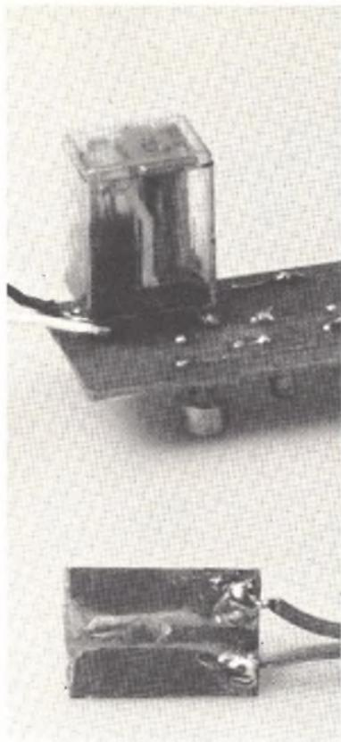
Un discorso a parte merita il sensore; noi abbiamo utilizzato una basetta ramata incisa come in figura. Però, col tempo il rame si è ossidato e quindi abbiamo pensato di farlo argentare. Abbiamo poi incollato il sensore dalla parte non ramata sul serbatoio, usando però una colla non solubile dal liquido che riempie la vasca. Se poi a qualcuno risultasse difficile far argentare il rame, potremmo consigliare di usare due spezzoni Ø
