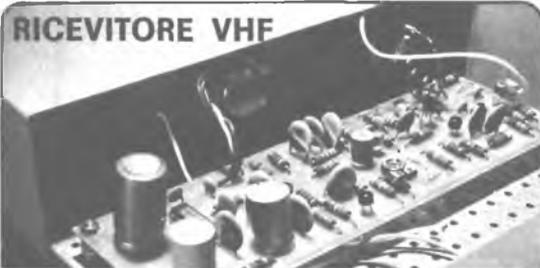
Semplice ricevitore superreattivo in grado di ricevere le trasmissioni della banda VHF. Progetto descritto nel numero di gennaio 1978.
