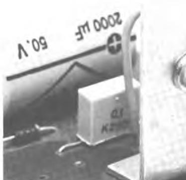
Nelle immagini due particolari del prototipo allestito nel nostro laboratorio. La corrente ricavabile dal circuito è diretta funzione della dissipazione termica del transistor di potenza. Il contenitore del semiconduttore è in diretto contatto con il piano di metallo del dissipatore.
