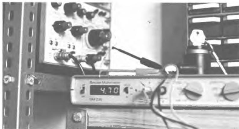
Vediamo insieme quali sono le motivazioni fondamentali del successo della strumentalizzazione digitale nel laboratorio del tecnico riparatore e dello sperimentatore. Consideriamo il multimetro Sinclair DM235.
