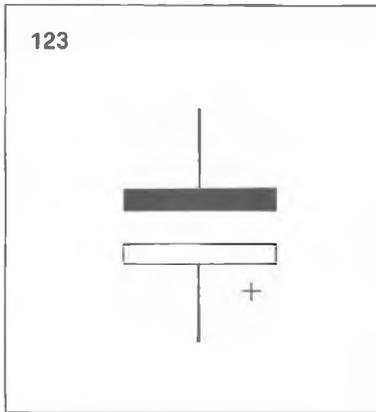
*Il trasformatore modifica l'ampiezza di una tensione alternata (fig. 122), nel disegno vedete in pratica un esempio di trasformatore ed il suo simbolo 123, elemento che contraddistingue il condensatore elettrolitico negli schemi teorici.*
