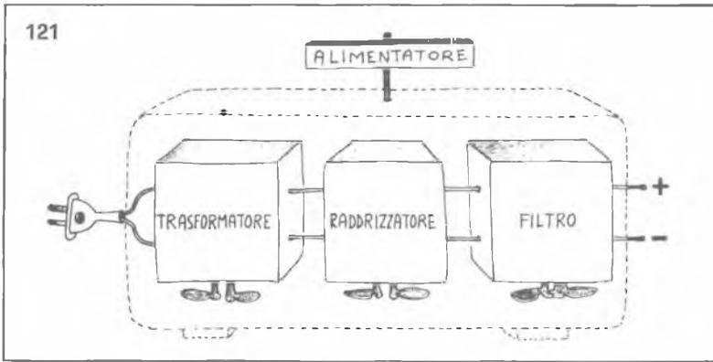
120, raddrizzatore a doppia semionda con grossa capacità in uscita: la tensione di uscita è praticamente continua. 121, le funzioni dell'alimentatore.
