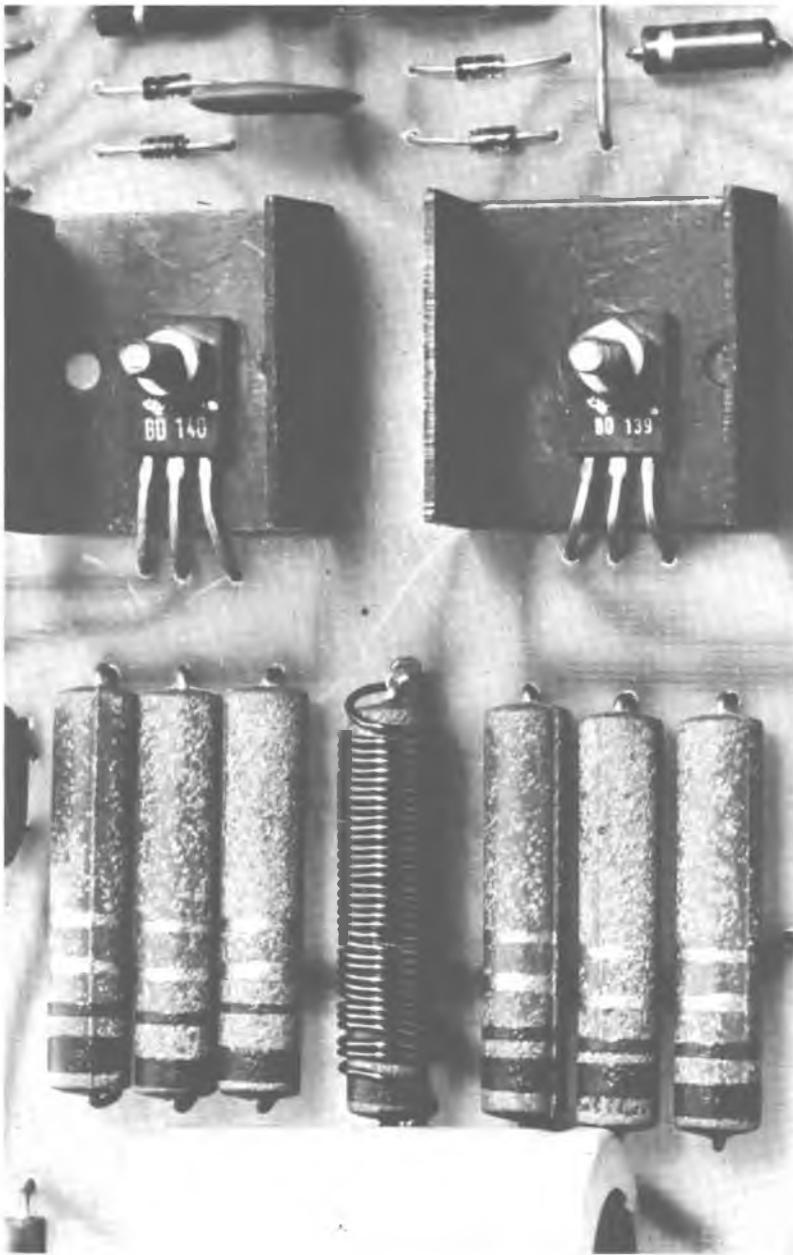
costruita. A tale scopo attorno ad una resistenza da 1 ohm 1 watt (R31) dovreste avvolgere una ventina di spire di filo di rame smaltato del diametro di 1 millimetro.
