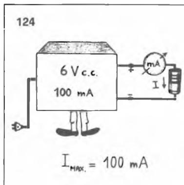
*In figura 124 troviamo rappresentato un alimentatore con le sue caratteristiche: la corrente massima è un elemento fondamentale. Nella pagina accanto, figura 127 esempio di come uno zener stabilizza la tensione al valore  $V_z$ .*
