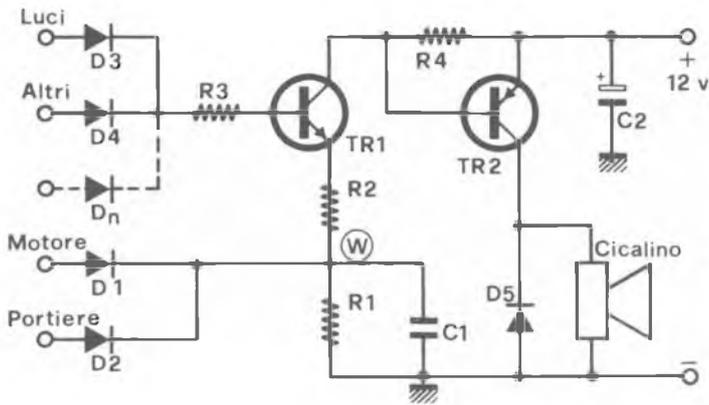
*Ecco le prime proposte per la realizzazione del circuito da installare sulla macchina per assolvere al compito di avvertire se tutte le luci sono state disattivate al momento dello spegnimento del motore. In questa pagina gli schemi 1 e 2, a fronte, lo schema della versione 3 che, scambiando fra loro i punti A e C diventa anche la soluzione numero 4.*
