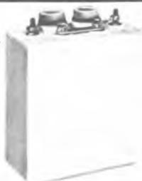
**NICHEL-CADMIO** a liquido alcalino, 2 elementi da 2,4 V 6 A/h in contenitore plastico. Ingombro 79x49x100 m/m. Peso kg. 0,63. Durata illimitata, non soffre nel caso di scarica completa, può sopportare per brevi periodi il c.c. Ideale per antifurti, lampade di emergenza, inverter, ecc. Può scaricare (per esempio): 0,6 A per 10 h oppure 1,2 A per 5 h oppure 3 A per 1,5 h ecc.
