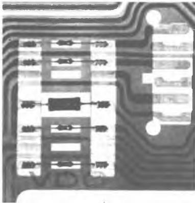
*Fra le anticipazioni della SGS-Ates vediamo in alto un modulo integrato di amplificazione per bassa frequenza e, immediatamente sopra, due regolatori di tensione della nuova serie L78.*
