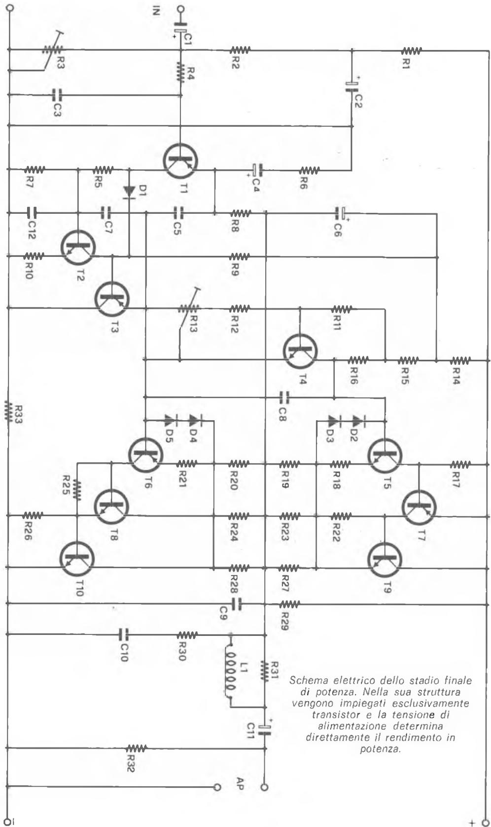
*Schema elettrico dello stadio finale di potenza. Nella sua struttura vengono impiegati esclusivamente transistor e la tensione di alimentazione determina direttamente il rendimento in potenza.*
