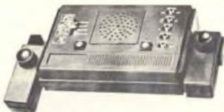
**TV GAME T-338 4 Giochi: TENNIS, HOCKEY, SQUASH, PRACTICE.** Commutatore ON-OFF, variazione angolo pallina da 20° a 40°, controllo velocità palla, variazione dimensione racchette, selezione servizio manuale o automatico. Un pulsante di START e uno per la rimessa manuale. Controllo a distanza delle racchette. Alimentazione a batterie o con alimentatore esterno **L. 25.000**
