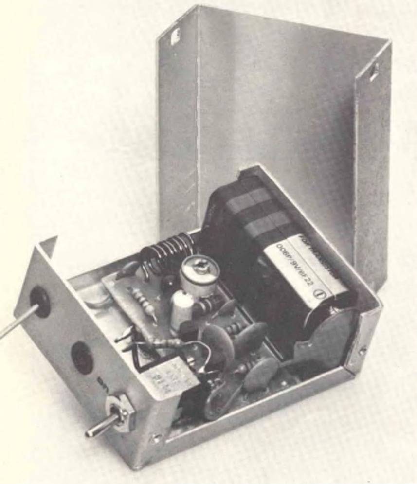
*Nell'immagine il dispositivo di allarme radio operante in modulazione di frequenza pronto per la chiusura del contenitore. L'alimentazione è ottenuta mediante una pila da 9 volt. L'antenna è il filo che fuoriesce.*
