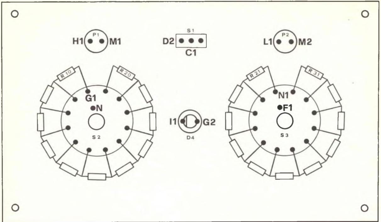
Indicazioni per la connessione delle resistenze di carico ai capi dei commutatori S2 ed S3.
