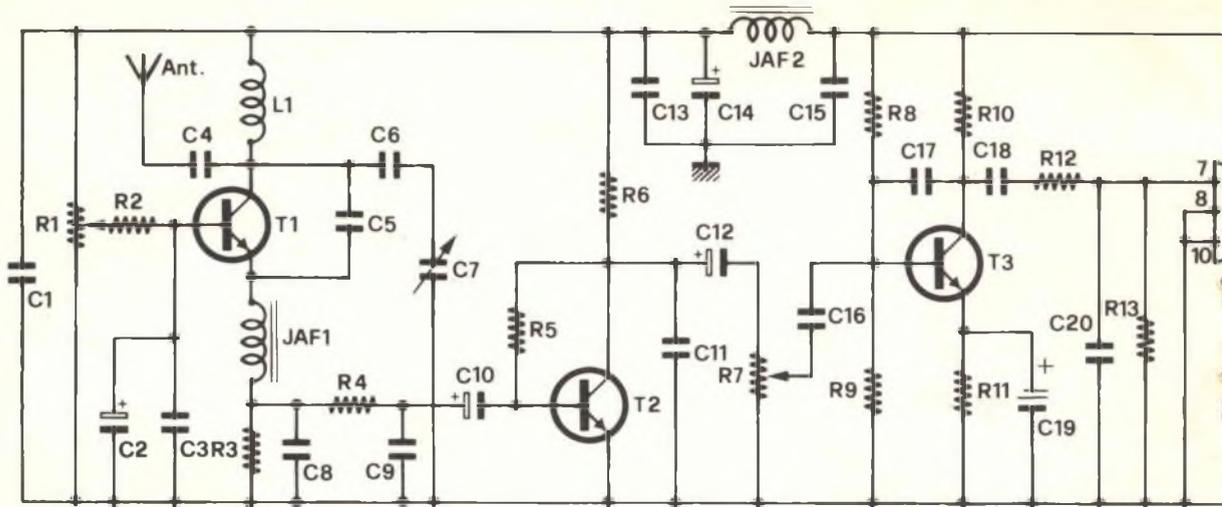
Schema elettrico generale del dispositivo per la ricezione in VHF.
