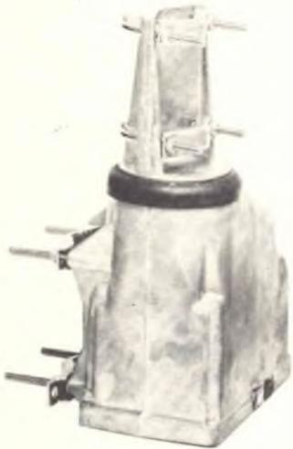
*In questa pagina troviamo l'antenna direttiva modello Spit-fire studiata per fornire un guadagno di 8 dB fra 26 e 30 MHz. L'orientamento dell'antenna è controllabile con il rotore semiautomatico modello 9505. L'efficienza del sistema si può tenere sotto controllo con il wattmetro/rosmetro FS 711/V.*
