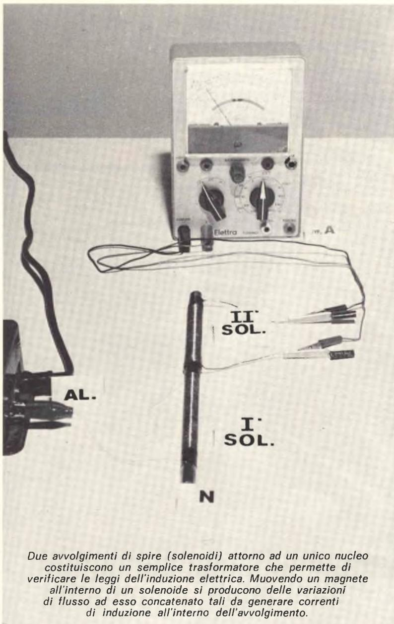
*Due avvolgimenti di spire (solenoidi) attorno ad un unico nucleo costituiscono un semplice trasformatore che permette di verificare le leggi dell'induzione elettrica. Muovendo un magnete all'interno di un solenoide si producono delle variazioni di flusso ad esso concatenato tali da generare correnti di induzione all'interno dell'avvolgimento.*
