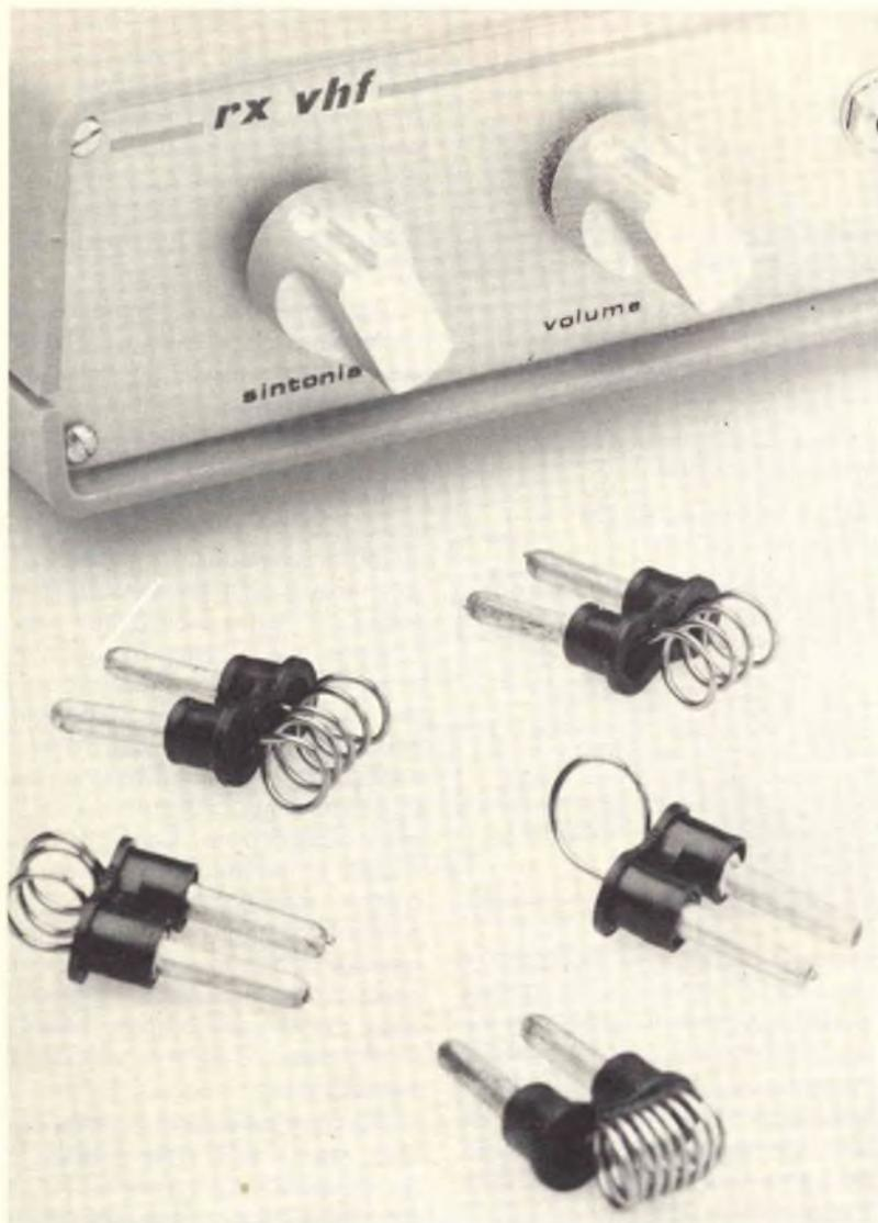
*Per cambiare lo spazio di frequenza ricevibile si deve operare la sostituzione della bobina dell'oscillatore. Allo scopo abbiamo preparato una serie di bobine saldate con particolare cura (ricordate che lavoriamo in alta frequenza) a spine ad elevato grado di isolamento.*
