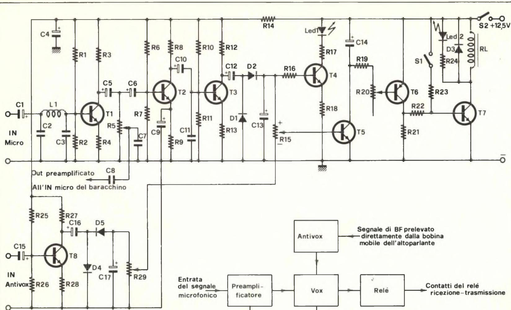
Schema elettrico generale e rappresentazione a blocchi delle funzioni circuitali. Il dispositivo è idoneo per l'applicazione a qualsiasi modello di radiotelefono per citizen's band o per altre gamme d'onda.
