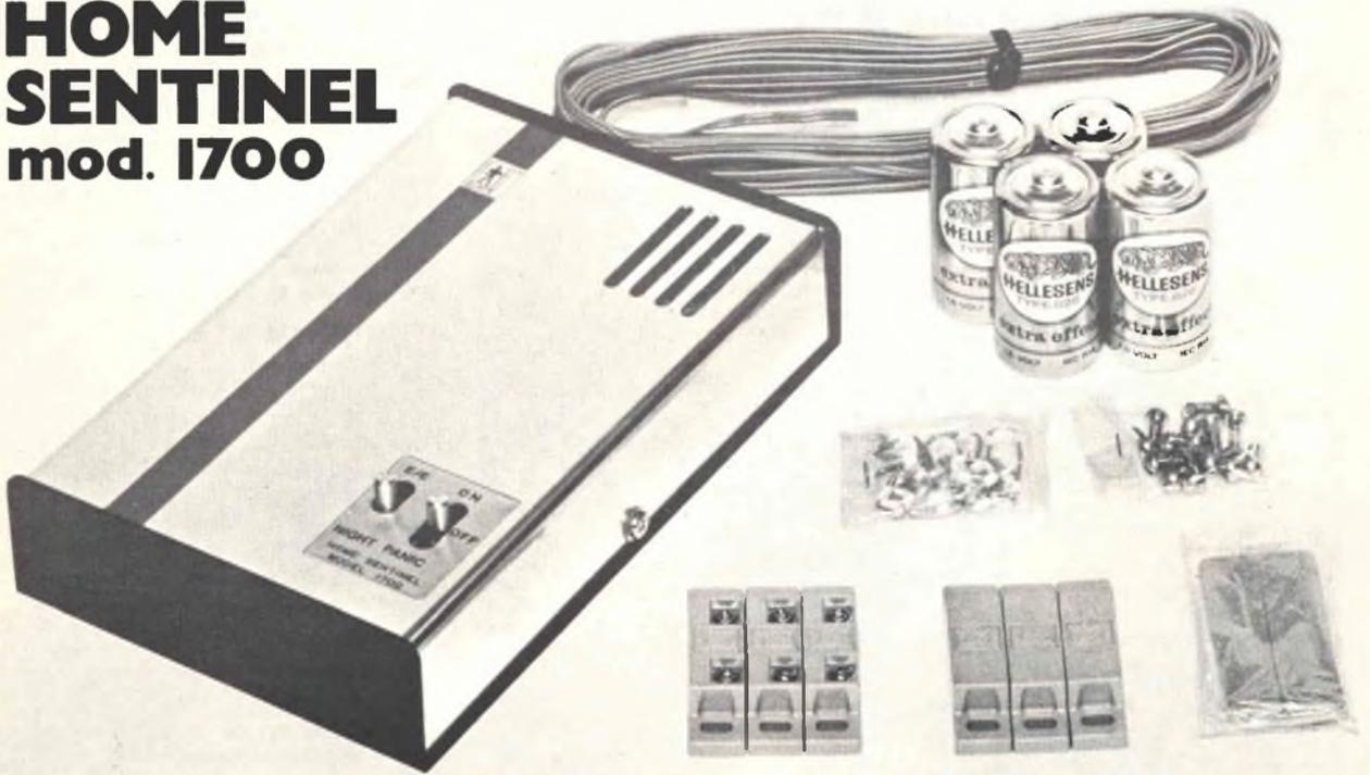
Per facile installazione, la centralina è alimentata a 6 Vc.c. con 4 pile a secco di lunga durata. Grazie all'integrato, impiegato nel suo circuito interno, essa presenta notevoli caratteristiche di sicurezza ed affidabilità. Utilizza come sensori dei contatti magnetici normalmente chiusi; l'intervento è di tipo ritardato all'ingresso ed all'uscita di 45 s.
