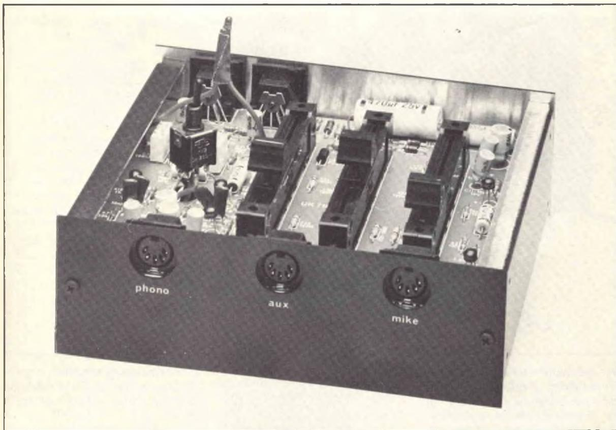
**I**l bisogno di un piccolo miscelatore che sia di elevate prestazioni si manifesta anche per utenti di esigenze sofisticate. Ogni qualvolta necessiti un apparecchio effettivamente portatile, che abbia la possibilità di una facile inserzione in circuito, con possibilità di adattamento a diverse linee di amplificazione a valle, l'UK 716 si rivela prezioso.
