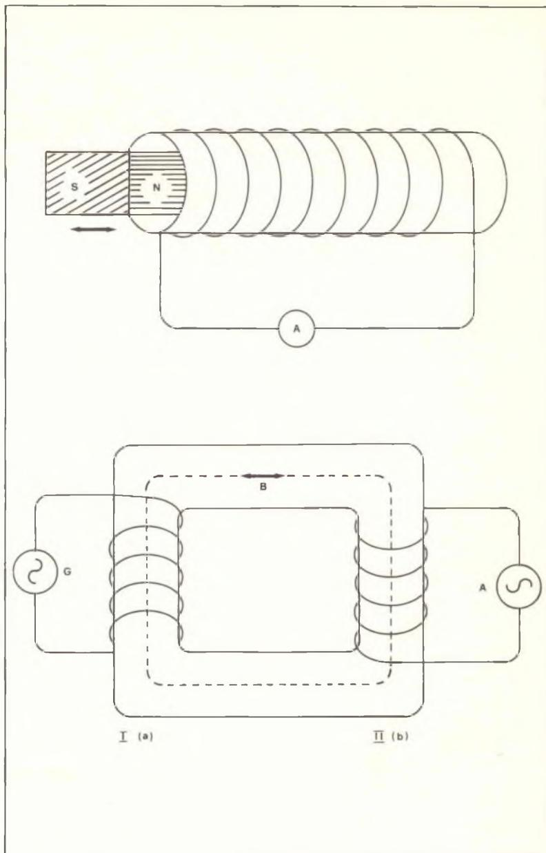
nera nella stessa una corrente che tenta di opporsi alla variazione iniziale». In pratica avviene che se diminuiamo in qualche modo il flusso di *B*, si formerà nella seconda spira una corrente (definita «indotta» e misurata dall'amperometro) il cui risultato è un secondo campo magnetico *B*<sub>2</sub> che tenta di rinforzare *B*, ovvero si oppone alla diminuzione iniziale. Conversamente, ad un aumento iniziale corrisponderà una corrente
