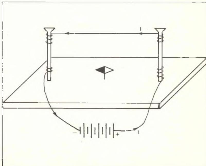
osservando di mantenerla ben in piano. Applicando agli estremi del nostro conduttore anche il debole potenziale di una pila (qualche volt) o di un qualunque altro generatore di corrente continua, noteremo l'ago della bussola orientarsi parallelamente al filo.
