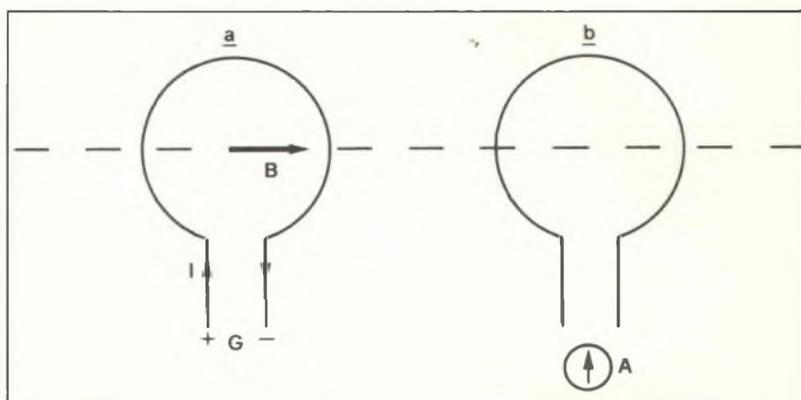
*In alto, rappresentazione di una spira e di un solenoide percorsi da corrente continua: gli elementi presentano polarità magnetica Nord e Sud. Immediatamente sopra, filo rettilineo percorso da corrente: genera un campo magnetico di cui non è possibile individuare le sorgenti (legge di Biot-Savart). Sotto, due spire affiancate parallelamente: il flusso variabile genera nella seconda correnti indotte.*
