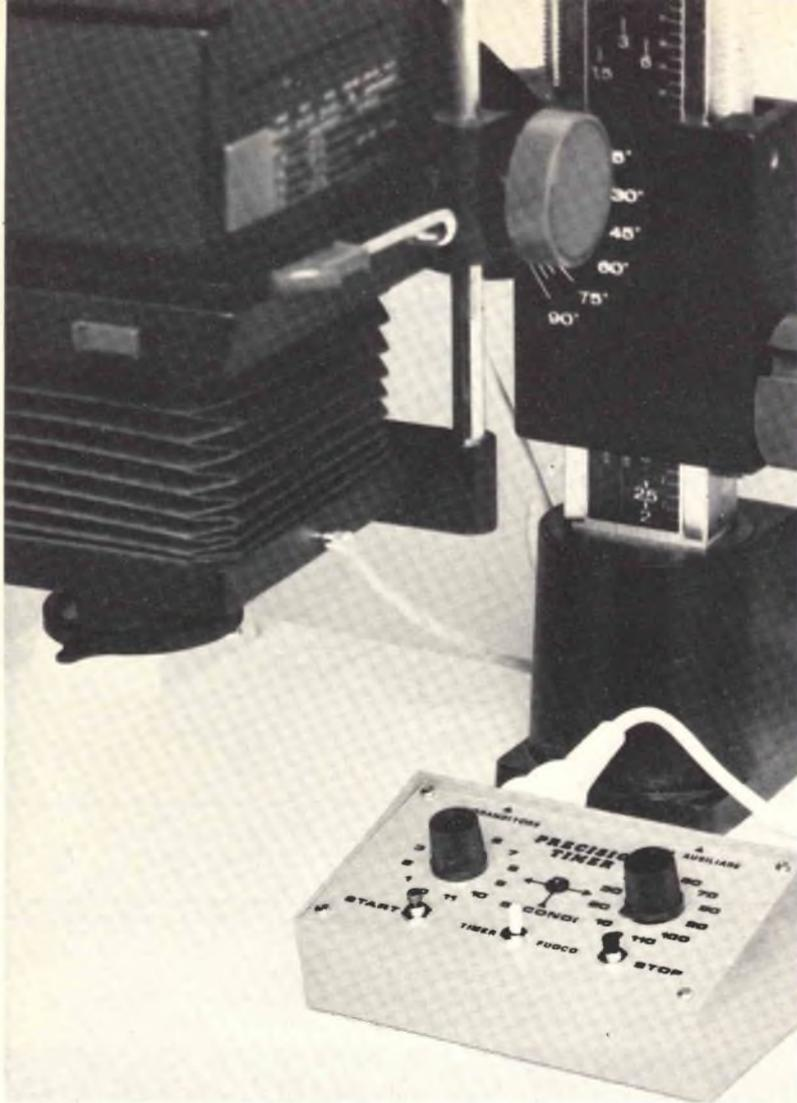
*Le uscite del temporizzatore, luce di lavoro e ausiliaria, sono predisposte per essere collegate direttamente all'ingranditore. Il disaccoppiamento avviene tramite un relè.
