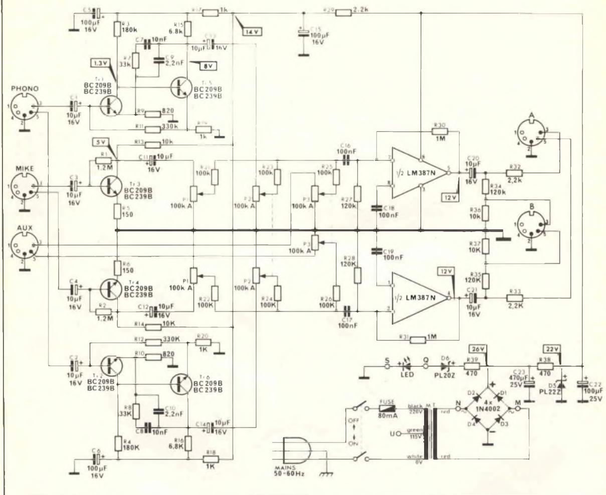
Tre potenziometri a cursore danno la facoltà di miscelare in ogni rapporto i segnali provenienti da un giradischi, da un microfono anche stereofonico, da un registratore ecc. L'uscita avviene a due livelli distinti e forniscono due tensioni normalizzate richieste dalla maggior parte dei sistemi di amplificazione in commercio.
