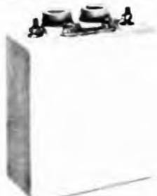
NICHEL-CADMIO a liquido alcalino, 2 elementi da 2,4 V 6 A/h in contenitore plastico. Ingombro 79x49x100 m/m. Peso kg. 0,63. Durata illimitata, non soffre nel caso di scarica completa, può sopportare per brevi periodi il c.c. Ideale per antifurti, lampade di emergenza, inverter, ecc. Può scaricare (per esempio): 0,6 A per 10 h oppure 1,2 A per 5 h oppure 3 A per 1,5 h ecc. La batteria viene fornita con soluzione alcaline in apposito contenitore.
