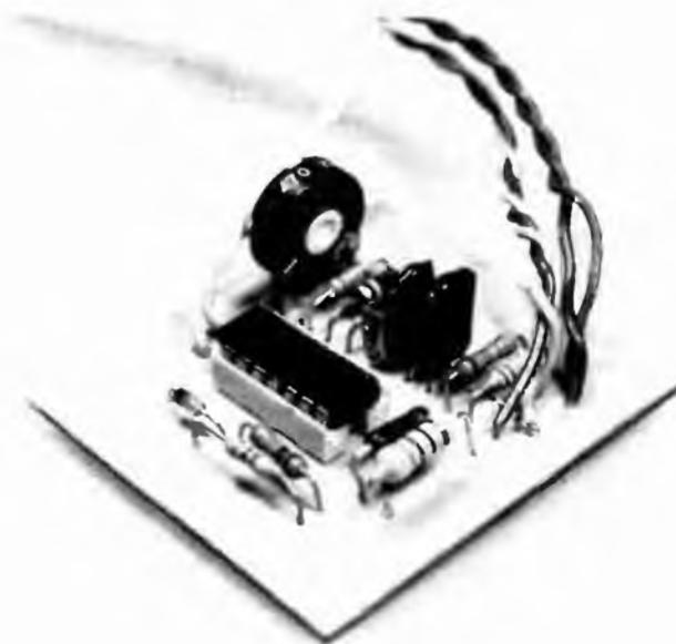
Convertitori frequenza/tensione per una serie di interessanti esperimenti da laboratorio. Applicazioni per un contagiri per auto, frequenzimetro analogico, interruttore comandato in frequenza o velocità, controllo di fuorigiri con memoria, capacimetro...
