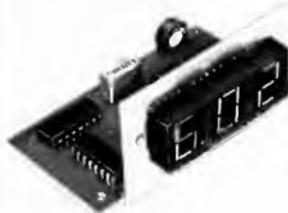
La tecnica digitale, che offre elevata precisione e chiarezza di lettura, è alla base di questo eccellente voltmetro a tre cifre per tensioni continue dal minimo di 1 mV al massimo di 999 V.
