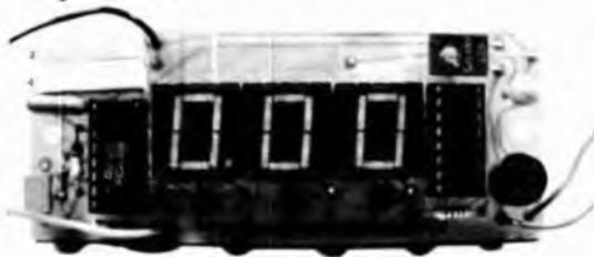
Voltmetro elettronico digitale sostituibile a qualsiasi modello di indicatore di tensione tradizionale, tre portate, tensione max 999 V. L. 22.000. (Trasformatore L. 1.800; commutatore L. 1.200; pannello con schermo rosso e minuterie L. 4.000).
