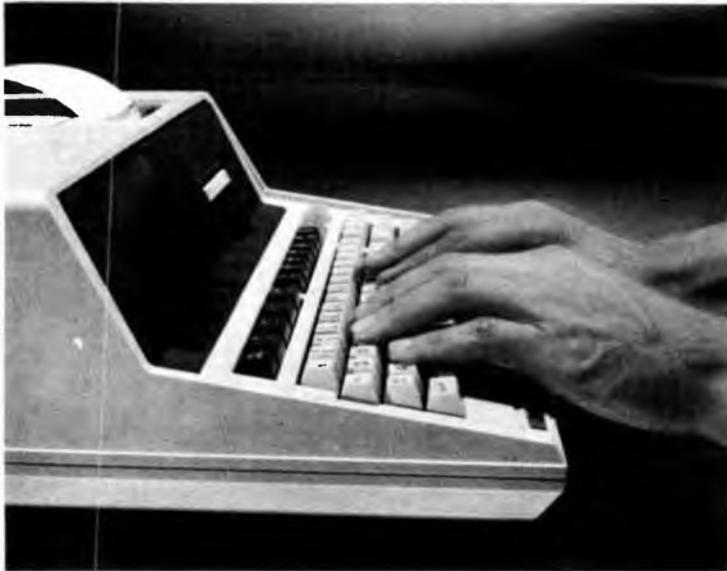
in un unico e comodo apparecchio portatile. L'HP-85 pesa soltanto 8 kg ed ha le stesse dimensioni di una macchina per scrivere elettrica portatile. Vi basta accendere l'HP-85 per averlo pronto per funzionare.
