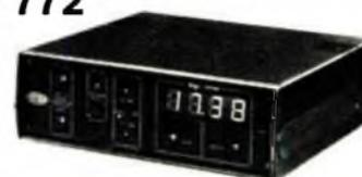
Concepito principalmente per l'accensione e lo spegnimento programmato di impianti di diffusione sonora. Può tuttavia essere usato per moltissime altre applicazioni. Alimentazione: 220 Vc.a. 50 Hz. Corrente assorbita: 350 mA c.a. Massima corrente commutabile: 5 A - 220 V (carico resist.) Display orologio: 24 ore. Regolazione indipendente delle ore e dei minuti.
