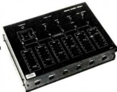
Si tratta di un mixer con caratteristiche decisamente professionali, adatto sia al funzionamento in sede fissa, sia per lavori fuori studio. Alimentazione: 115-220-250 Vc.a. 50/60 Hz. Ingressi: 4 stereo + mono. Impedenza ingresso: phono 1-2; 47 k $\Omega$ . Tape-aux 470 k $\Omega$ ; micro 120 k $\Omega$ . Impedenza d'uscita: 4,7 k $\Omega$ . Sensibilità: phono 1-2; 4 mV; Tape-aux 120 mV; micro, 1-3-5 mV. Distorsione: < 0,3%. Uscita cuffia (stereo): 8  $\Omega$
