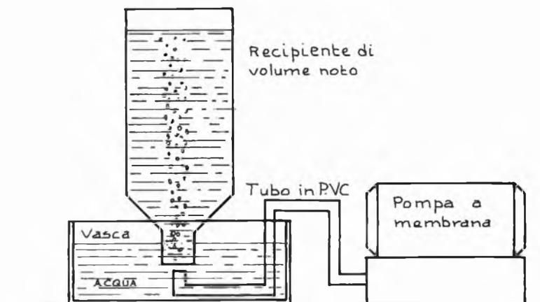
Per determinare il flusso della pompa basta misurare il tempo necessario per scacciare l'acqua da un recipiente di volume noto.  $V/t$  è il flusso.
