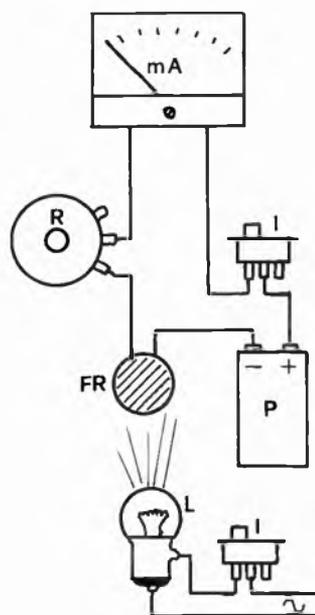
Schema densitometro: L 3c 220V; FR = GBC Y0-4402-00 fotoresistenza; R pot. 1000 ohm; mA = 100 mA fs; P = stabilizzato 9-12 V o naturalmente pila. Nella foto il densitometro costruito.
