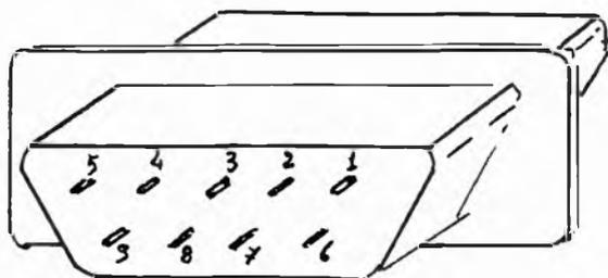
Connettore alimentazione: 2 = 5V; 3 = 5V; 4 = 5V; 6,9 = GND.
