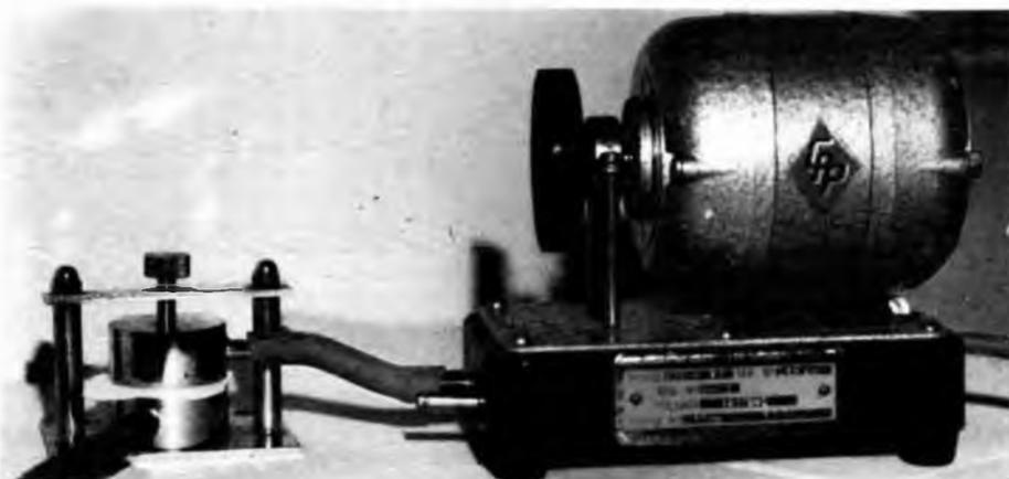
pa a membrana tipo quelle che si usano per areare le vasche dei pesci, solo che, invece di usarla come pompa premente bisogna usarla come pompa aspirante.
