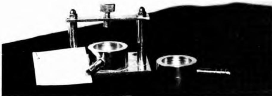
*Portafiltro con filtro aperto e sotto pompa aspirante per campionare l'aria.*
