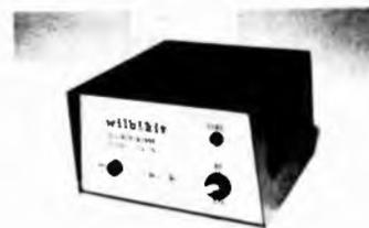
Alimentatore stabilizzato da 12 volt particolarmente idoneo per il funzionamento di radiotelefoni. Circuito a basso livello di ripple ed elevata stabilità anche nelle condizioni di massimo carico (2 ampere). Le dimensioni particolarmente ridotte consentono una facile sistemazione nel laboratorio o nella stazione radio. L'apparecchio è disponibile esclusivamente montato e collaudato.
