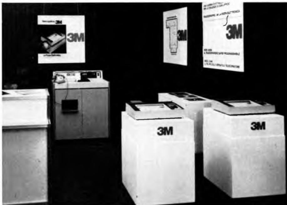
A differenza di altri apparecchi esistenti sul mercato, il 9600 è completamente automatico. L'innovazione più rilevante consiste nella capacità di scegliere automaticamente la velocità di trasmissione in funzione della qualità della linea telefonica. Ciò consente di avere in ogni occasione la massima fedeltà.
