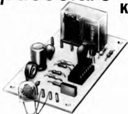
Dispositivo di sicuro funzionamento che permette di azionare comandi o più semplicemente di accendere delle luci quando l'illuminazione ambiente scende al di sotto di un
