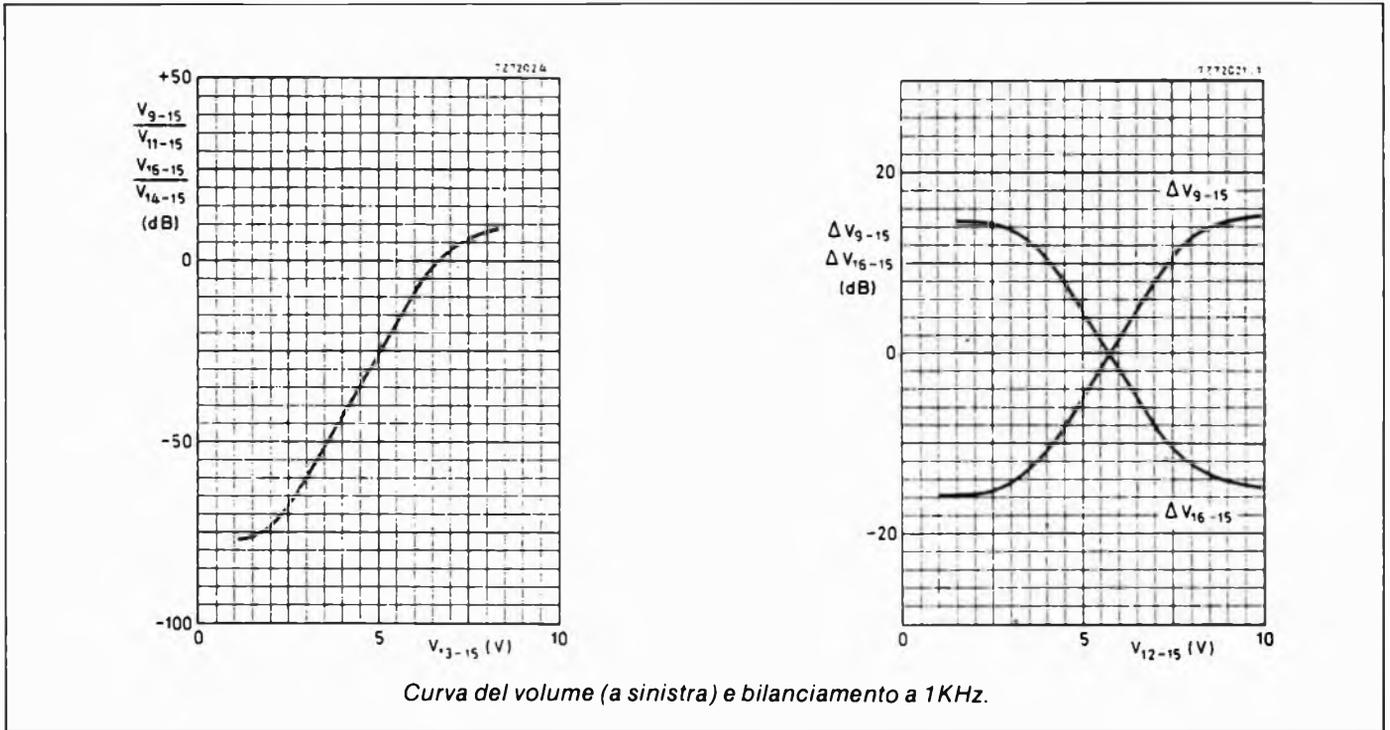
se regolato a  $-20$  dB, è possibile effettuare una regolazione di bilanciamento compresa tra  $+e-10$  dB. La differenza di amplificazione tra il canale sinistro e il canale destro può raggiungere in questa maniera il massimo di 20 dB.
