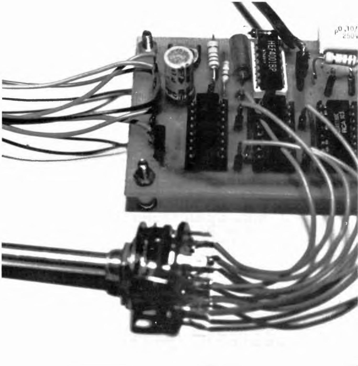
*Un circuito di agevole costruzione e molto economico, da utilizzare magari con il tester. Sono utilizzati integrati Cosmos che ci permettono di effettuare misure di frequenza abbastanza precise sino a 10 MHz.*
