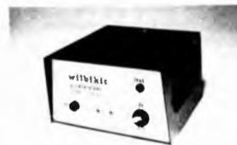
Alimentatore stabilizzato da 12 volt particolarmente idoneo per il funzionamento di radiotelefonii. Circuito a basso livello di ripple ed elevata stabilità anche nelle condizioni di massimo carico (2 ampere). Le dimensioni particolarmente ridotte consentono una facile sistemazione nel laboratorio o nella stazione radio. L'apparecchio è disponibile esclusivamente montato e collaudato.
