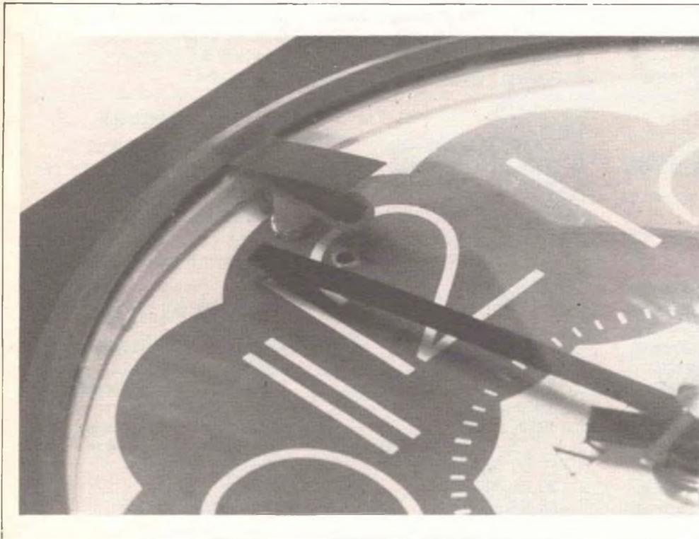
**Foto 6.** Particolare del sistema optoelettronico; si scorge la lancetta dei minuti.
