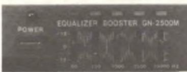
Tasto e spia luminosa per l'accensione. Bypass. Comandi di controllo frequenza a 5 slider su: 60, 250, 1.000, 3.500, 10.000 Hz. Visualizzazione a led su ogni slider. Potenza d'uscita 2 x 30 Watts. Impedenza d'uscita 4 - 8 Ohm. Risposta di frequenza 20 - 30.000 Hz. Alimentazione 12 Vc.c. negativo a massa. Dimensioni: 90 x 30 x 120 mm.
