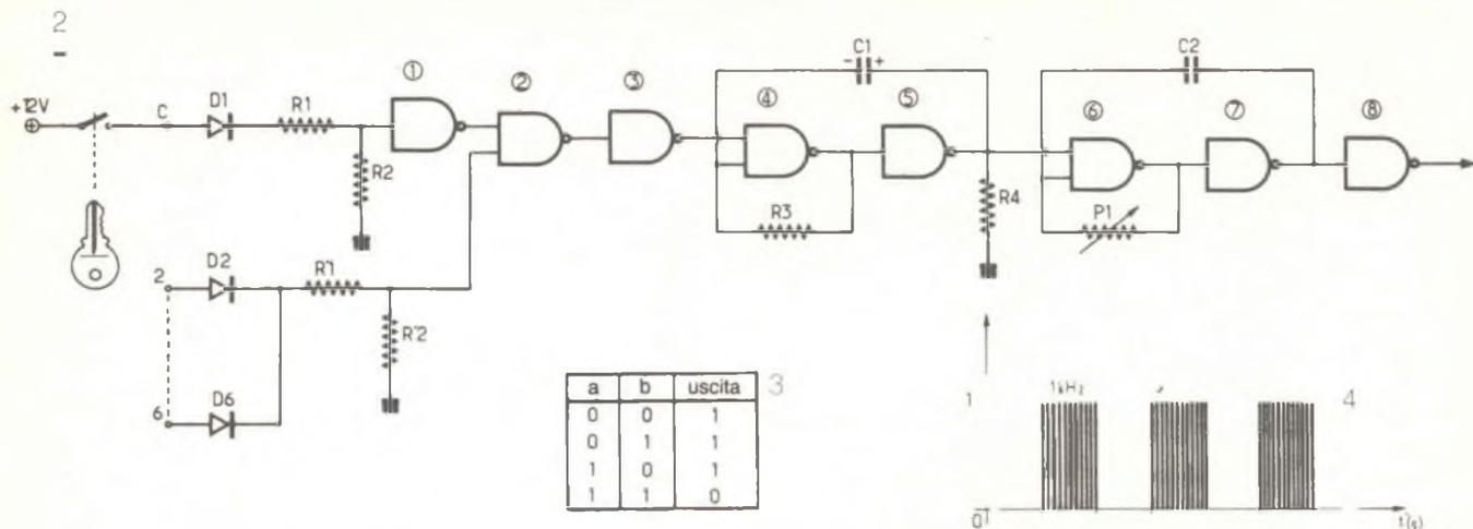
Figure 2, 3 e 4. L'assieme fa ricorso a porte NAND contenute in un SN 7400 e impiegate come invertitore e oscillatore. La tabella della verità di una porta NAND consente di comprendere meglio queste diverse possibilità.
