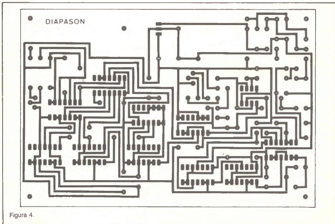
de un contatore per 2 e uno per 5 indipendenti. In questo caso è stato impiegato il contatore per 5. Il segnale disponibile sul piedino 11 di CI<sub>3</sub> viene diviso nuovamente per 5 mediante CI<sub>4</sub>. Si ottiene così sul piedino 11 un segnale la cui frequenza è più piccola 5 x 5 della frequenza originale, ossia:
