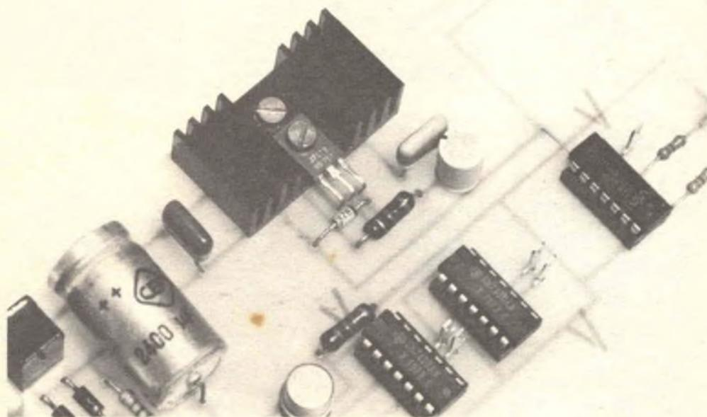
Foto 2. Si munisca di radiatore il transistor  $T_1$ .
