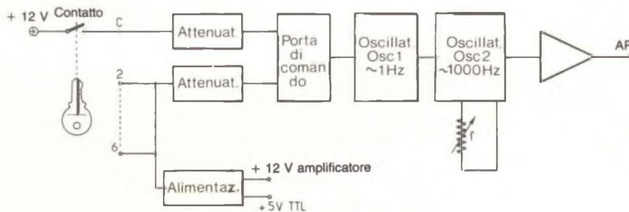
Figura 1. Schema a blocchi del dispositivo: dando contatto si inibiscono, tramite un attenuatore e una porta di comando, i due oscillatori che provvedono al suono di avvertimento.
