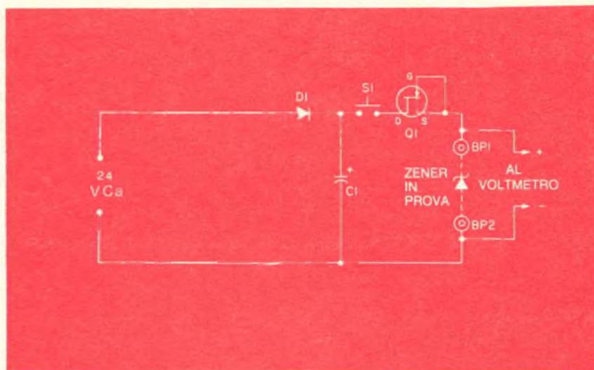
tore di corrente  $Q_1$  e il diodo in prova.  $Q_1$  regola la corrente a un valore di circa 10 mA a prescindere dalla tensione Zener. Potete impiegare il vostro strumento di misura universale o voltmetro per osservare la caduta di tensione attraverso
