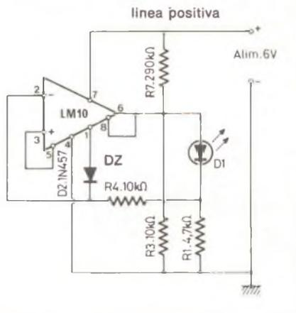
vegliare, e quindi a 9 V. Il consumo di questo apparecchio è molto debole, di appena qualche milliamperè, e non contribuisce molto all'usura della batteria o alla scarica dell'accumulatore. È stata indicata nello schema la tensione di avvertimento che è di 6 V. In realtà le cose vanno così.
