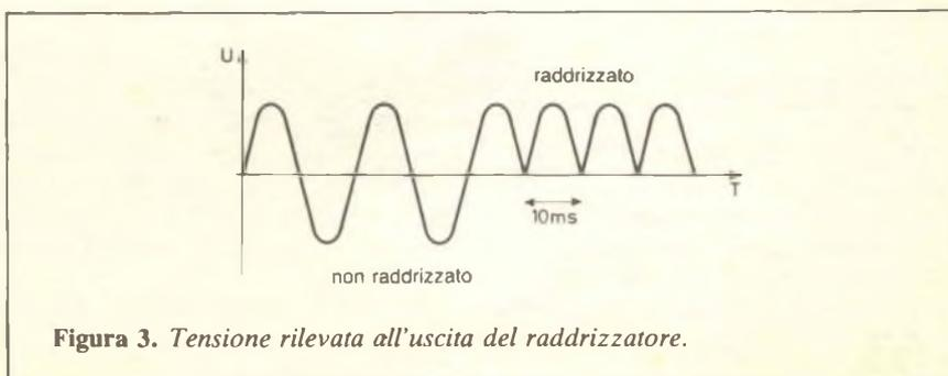
Figura 3. Tensione rilevata all'uscita del raddrizzatore.
