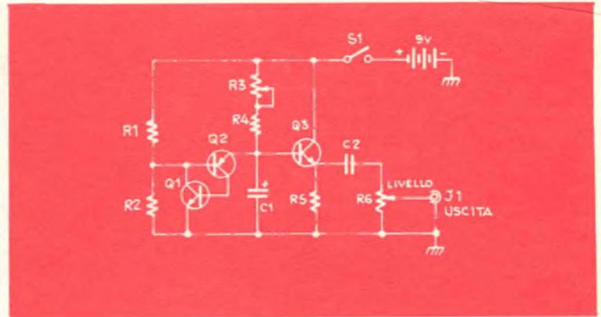
$R_6$ . Durante il periodo d'attacco del suono ruotate  $R_3$  per aumentare l'altezza del suono mentre il livello sale. Durante il decadimento fate scendere l'altezza del suono.
