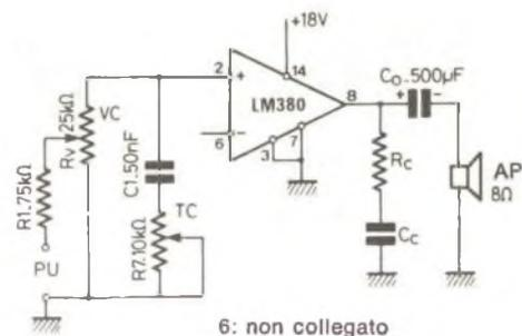
Per un buon disaccoppiamento il condensatore sarà ceramico a disco, ma lo sperimentatore può provare qualsiasi altro tipo di condensatore. Attenzione, però, un'oscillazione AF è ovviamente inudibile. La si può individuare solo con l'oscilloscopio.
