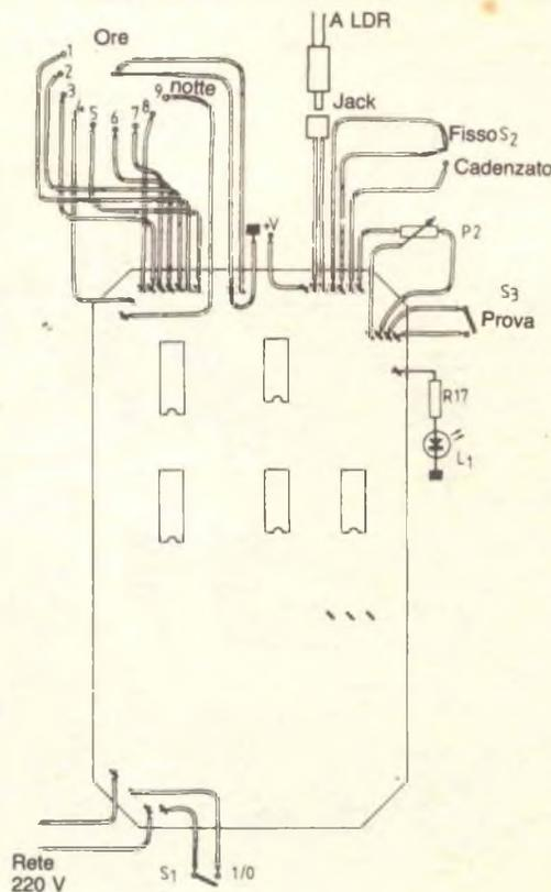
Figura 8. Schema di cablaggio generale del dispositivo con le connessioni con i componenti esterni.
