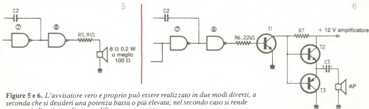
Figure 5 e 6. L'avvisatore vero e proprio può essere realizzato in due modi diversi, a seconda che si desideri una potenza bassa o più elevata; nel secondo caso si rende necessaria l'aggiunta di un amplificatore a transistor.
