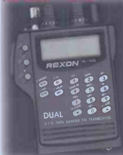
El Rexon RL-501 es el primer bibanda de Pihernz. Este equipo, que opcionalmente puede contar con CTCSS, tiene 40 memorias entre las dos bandas (ampliables a 100), tres tipos de barrido, doble escucha, tres niveles de potencia, llamada selectiva 8 con ocho memorias para códigos personales, etc.
