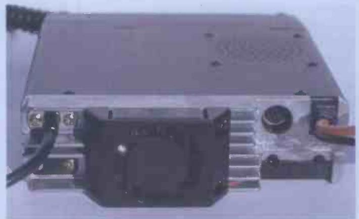
El ventilador posterior ayuda a mantener la temperatura en un régimen aceptable cuando se realizan transmisiones muy prolongadas a plena potencia.
