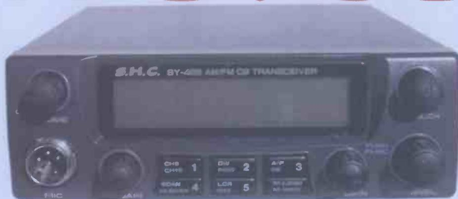
un modelo de dimensiones bastante reducidas, identificado a nivel interno por la utilización de componentes de montaje superficial (SMD), micrófono con selección de canales arriba/abajo incorporada, cinco memorias, posibilidad de doble escucha, barrido, supresor de parásitos, etc.
