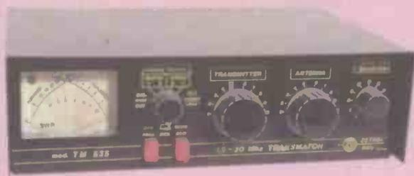
El TM 535 es un acoplador de antena capaz de ajustar el elemento radiante en transmisiones entre los 1.5 y los 30 MHz, por lo que cubre las bandas de HF, siendo operativo también en Banda Ciudadana. La potencia máxima que se le puede aplicar es de 500 vatios.
