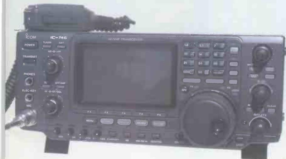
El 746 es la última innovación de Icom en equipos de decimétricas, aunque por sus prestaciones es más que eso. Este transmisor cubre las bandas de HF, la de 50 MHz y el VHF de aficionado, con recepción desde 300 KHz a 29,700 MHz, 50 a 54 MHz y 144 a 148 MHz en todos los modos.
