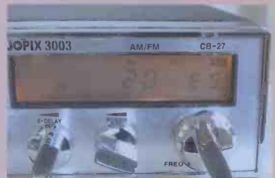
color con la tecla «Light». Para alternar la visualización de la frecuencia o del canal se actúa sobre «función» y después se presiona el mando del dial. Para quienes quieran resaltar su voz en transmisión, la 3003 le ofrece el eco con volumen y retardo seleccionables. Hay que tener precaución de no abusar del eco porque puede lle-
