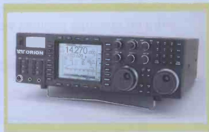
cia intermedia tanto a cristal como con procesador digital de señal de 32 bits. El segundo receptor tiene cobertura continua, comenzando en 100 KHz y terminando en 30 MHz. Éste también tiene DSP en la frecuencia intermedia. Los dos receptores se pueden uti-
