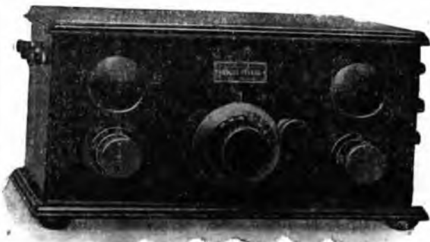
Apparecchio a 2 valvole tipo R 18
