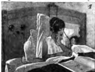
L'originalissima installazione radiofonica. Tutti gli organi componenti un radiorecettore a tre valvole sono montati poste-
