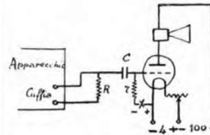
schizzo qui riportato. R è una resistenza fissa da 100.000 ohm. r è una resistenza fissa da 4 Megohm, C è un condensatore fisso da 0.5 Mfd. Provi ad invertire i fili d'entrata della resistenza R ai morsetti della cuffia; come pure può provare ad inserire una pila a secco nel punto segnato X. Usi una
