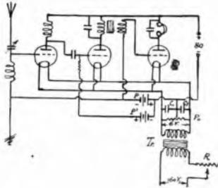
Lo schema indicato è per un ricevitore corrente a tre valvole: 1 amplificatore A. F. + 1 Rivelatrice + 1 Amplif. B. F. E' facile ricavare l'applicazione del metodo per il suo circuito che non conosciamo. Comunque se non vi riuscisse ci mandi il suo schema che ne faremo noi la modifica opportuna.
