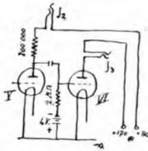
indicate le posizioni esatte dei jacks, della batteria di griglia dell'ultima valvola (che è necessaria e delle tensioni anodiche di 80 e 120 volt.
