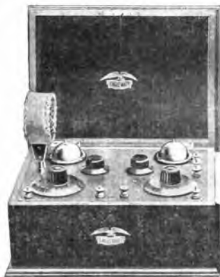
Apparecchio EAGLEWATT a due valvole
