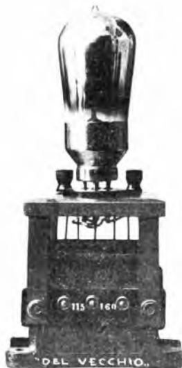
L'apparecchio per caricare una batteria di accumulatori di 12 Volts può essere utilizzata direttamente
