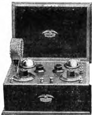
Apparecchio EAGLEWATT a due valvole
