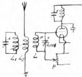
due condensatori d'aereo da 0.001 Mfd. dalla posizione in serie a quella di parallelo con la bobina d'aereo.
