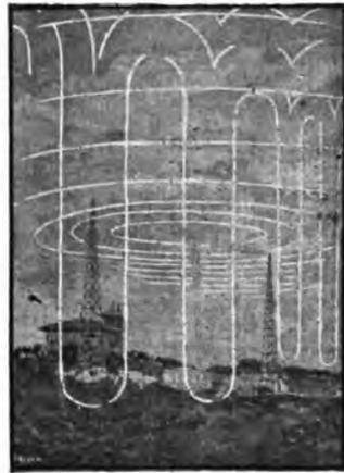
Figurazione grafica delle cariche e scariche elettriche che producono pulsazioni di pressione nell'etere, le quali generano le onde della T.S.F. Si consideri l'antenna, l'aria e la terra come formanti un gigantesco condensatore, nel quale i fili realizzano una placca del condensatore, l'aria è il dielettrico e la terra l'altra placca.
